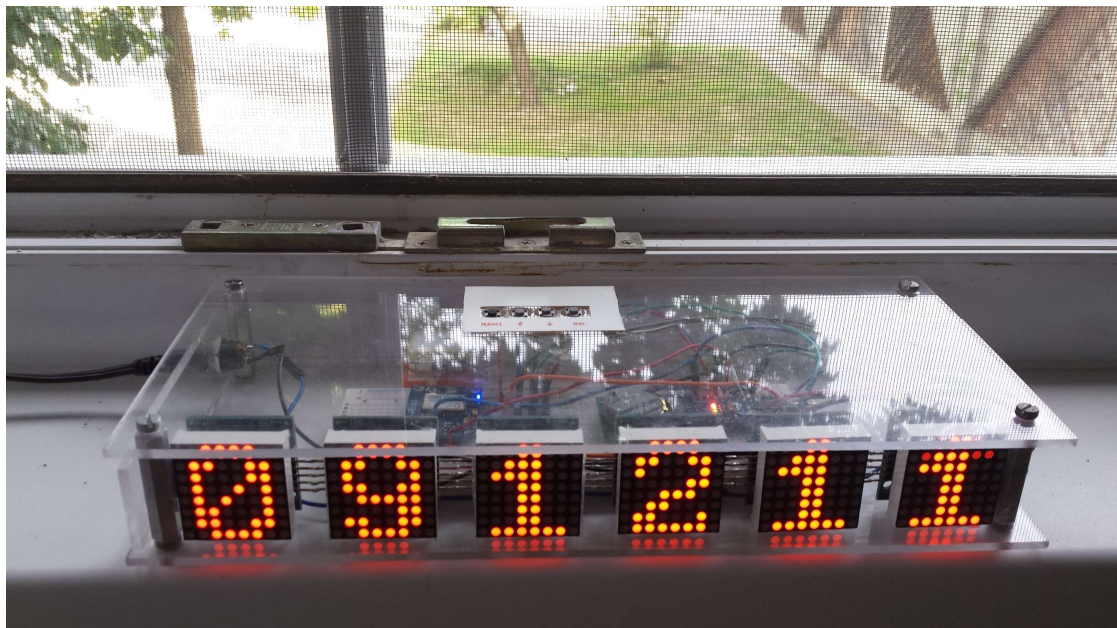
Sl. 4.2.: Sklop s kućištem uz stabilnu vezu sa satelitom i sinkronizacijom.
