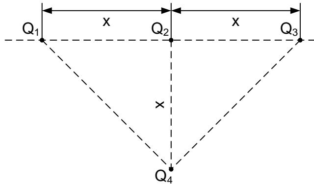
Odredimo vektore udaljenosti naboja  $Q_1$ ,  $Q_2$  i  $Q_3$  od naboja  $Q_4$ . Kako je neki vektor jednak umnošku njegove duljine i pripadnog mu jediničnog vektora može se Coloumbov zakon napisati i u slijedećem obliku.
