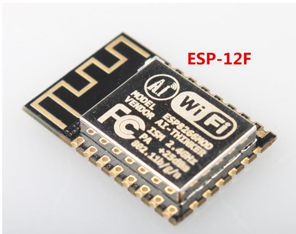
Slika 5. ESP8266 ESP-12F komunikacijski modul
