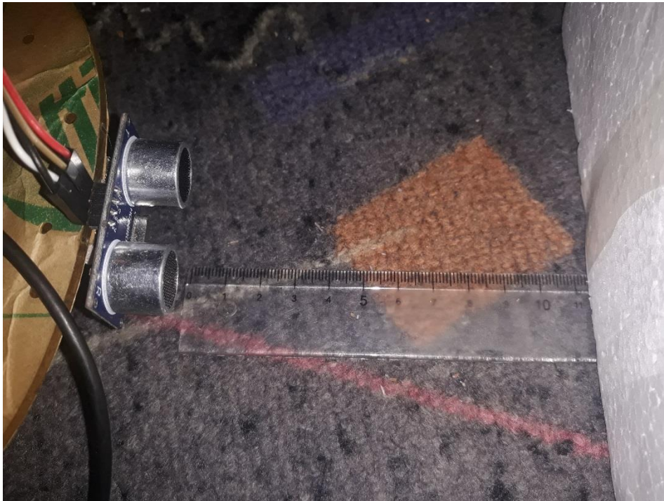
Slika 36. HCSR-04 senzor na udaljenosti od 11cm
