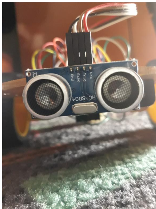
Slika 15. HC-SR04 senzor na robotskim kolicima
