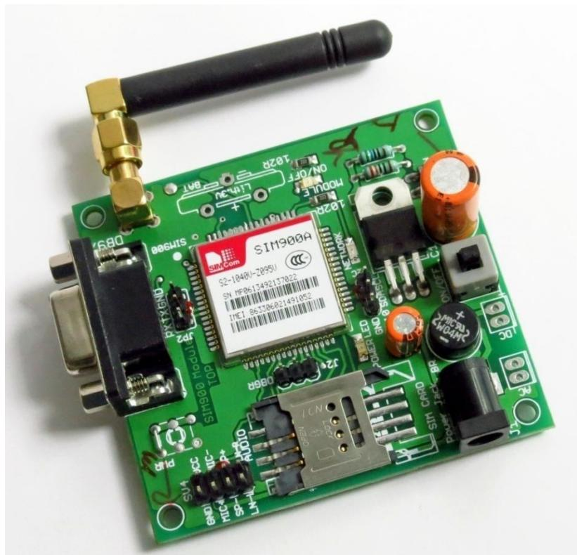
Sl. 3.3.: GSM modul za arduino.<sup>4</sup>
