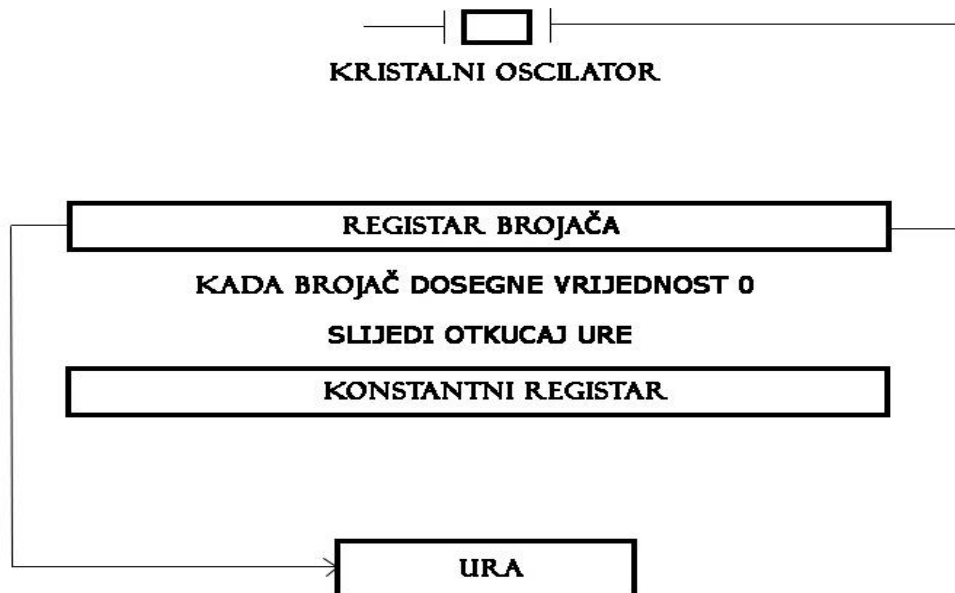
Sl. 2.2.: Opći model računalne ure. 1
