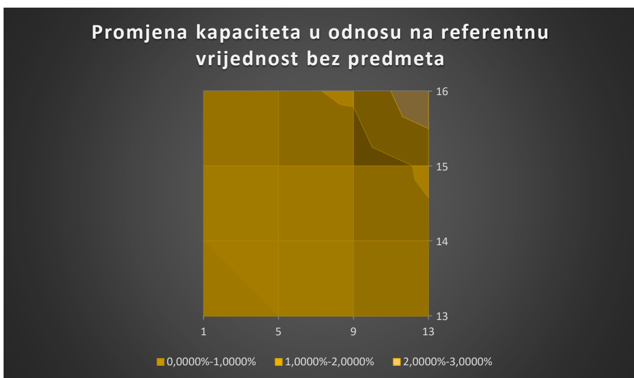
Sl. 4.18. Površinski grafikoni koji prikazuju promjenu kapaciteta u odnosu na referentnu vrijednost bez predmeta, prikazan odozgo.
