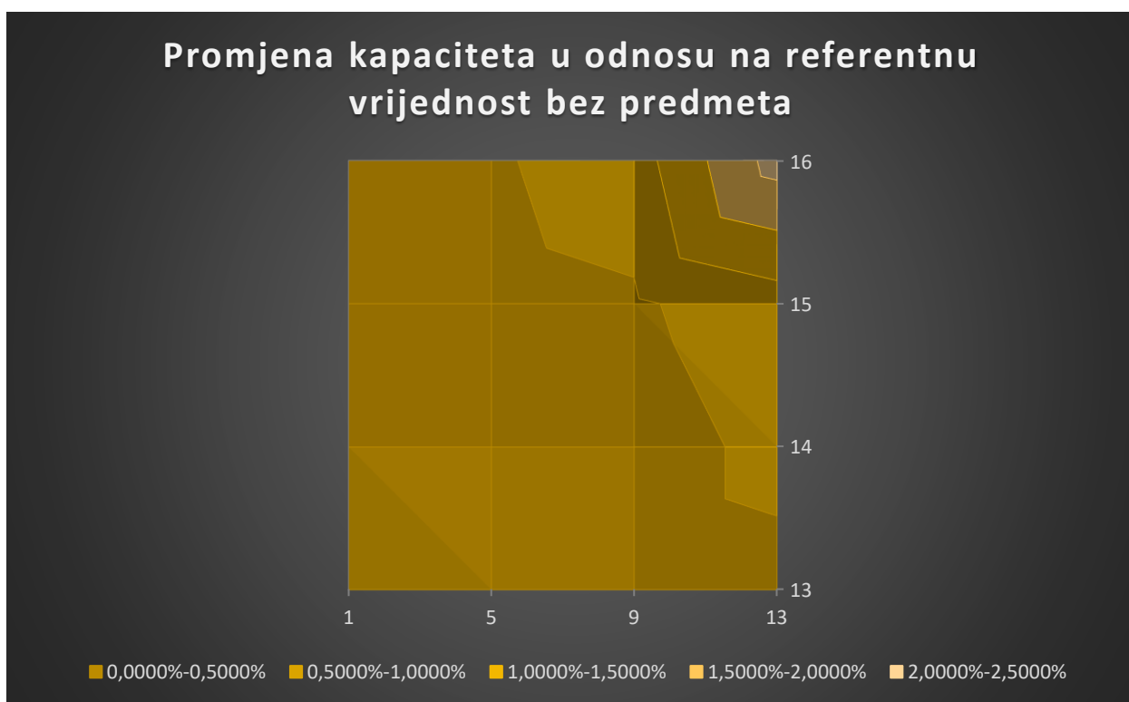
Sl. 4.3. Površinski grafikon koji prikazuje promjenu kapaciteta u odnosu na referentnu vrijednost bez predmeta, dvodimenzionalni prikaz.
