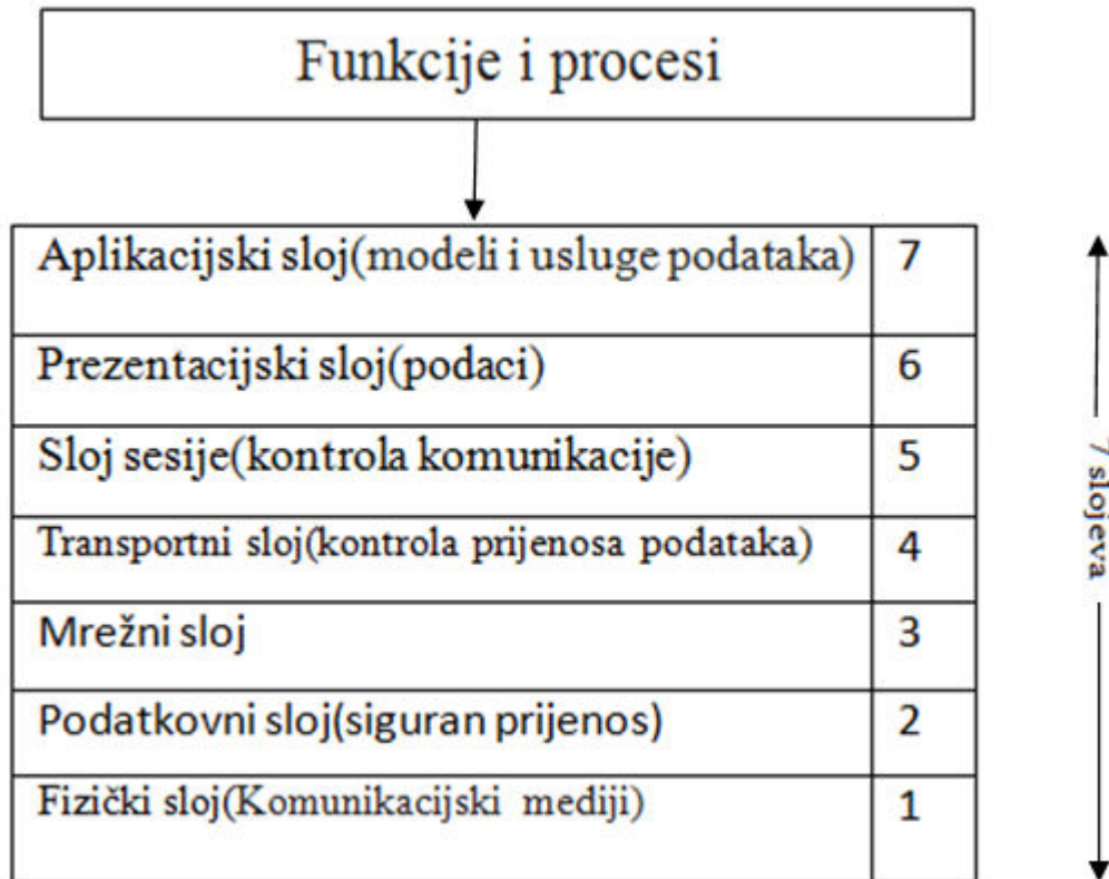
Slika 4.2. ISO / OSI komunikacijski referentni model [34]
