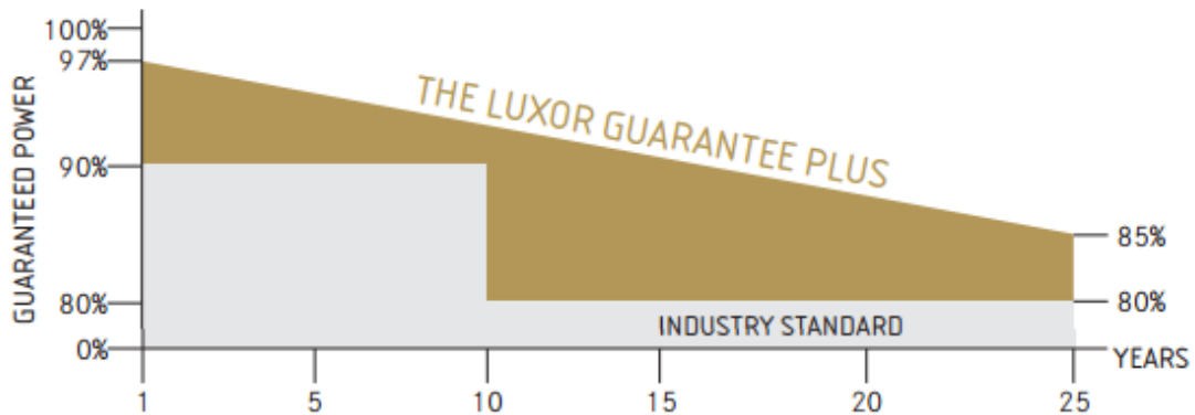
Sl.9. Iskoristivost snage u ovisnosti o godini starosti fotonaponskog modula [3]
