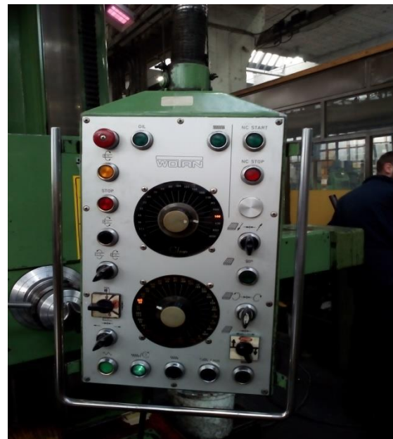
Slika 4.25. Upravljačka ploča borverka, (Fotografirano 12.11.2016.)
