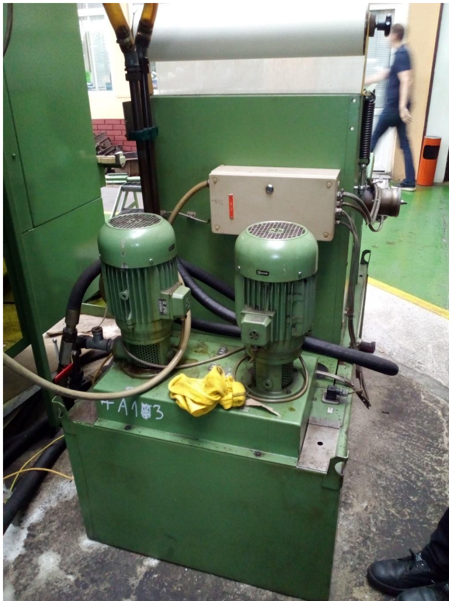
Slika 4.47. Glavni motori za pogon uljne pumpe, (Fotografirano 12.11.2016.)
