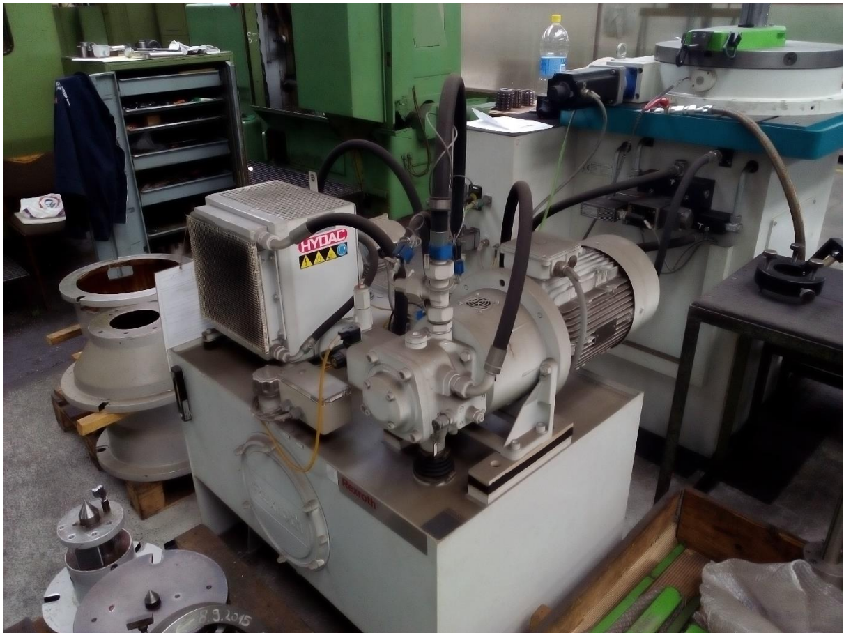
Slika 4.38. Pogon stroja za dubljenje utora zupčanika, (Fotografirano 12.11.2016.)
