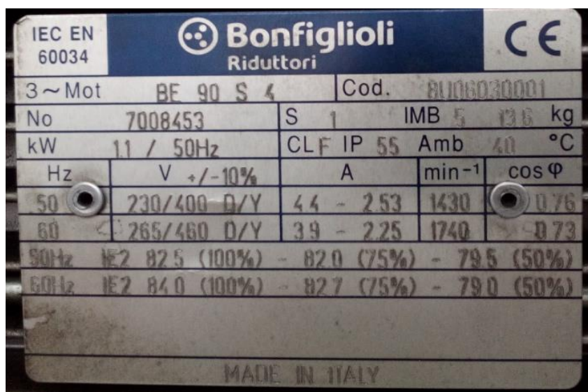
Slika 4.12. Natpisna pločica elektromotora koji pogoni pužni prijenos, (Fotografirano 12.11.2016.)
