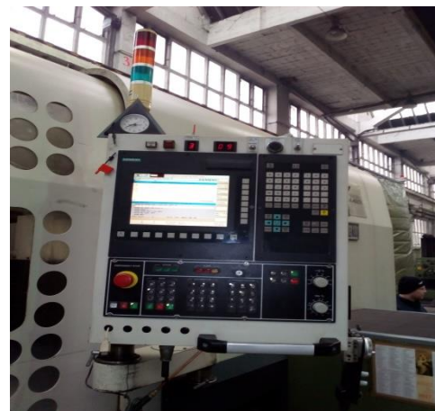
Slika 4.4. Upravljačka ploča tokarilice Karusel CNC, (Fotografirano 12.11.2017.)
