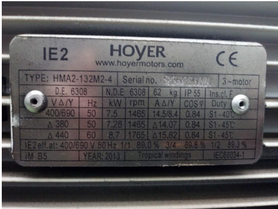
Slika 4.40. Natpisna pločica glavnog pogonskog motora stroja za dubljenje utora zupčanika, (Fotografirano 12.11.2016.)
