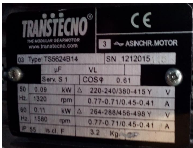
Slika 4.16. Natpisna pločica EM za podmazivanje stroja 1, (Fotografirano 12.11.2016.)
