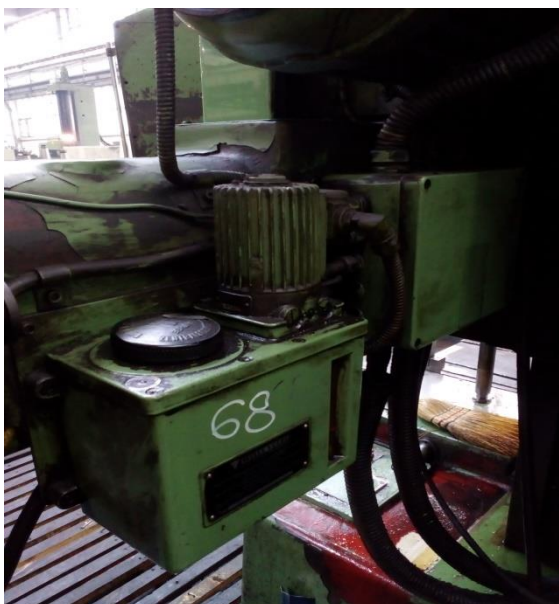
Slika 4.24. Elektromotor borverka, (Fotografirano 12.11.2016.)
