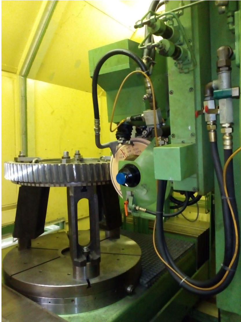
Slika 4.44. Stroj za brušenje zubi zupčanika, (Fotografirano 12.11.2016.)
