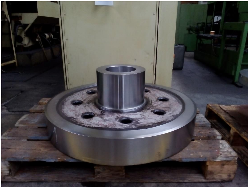
Slika 2.4. Okrugli komad željeza prije strojne obrade ozubljenja, (Fotografirano 12.11.2017.)
