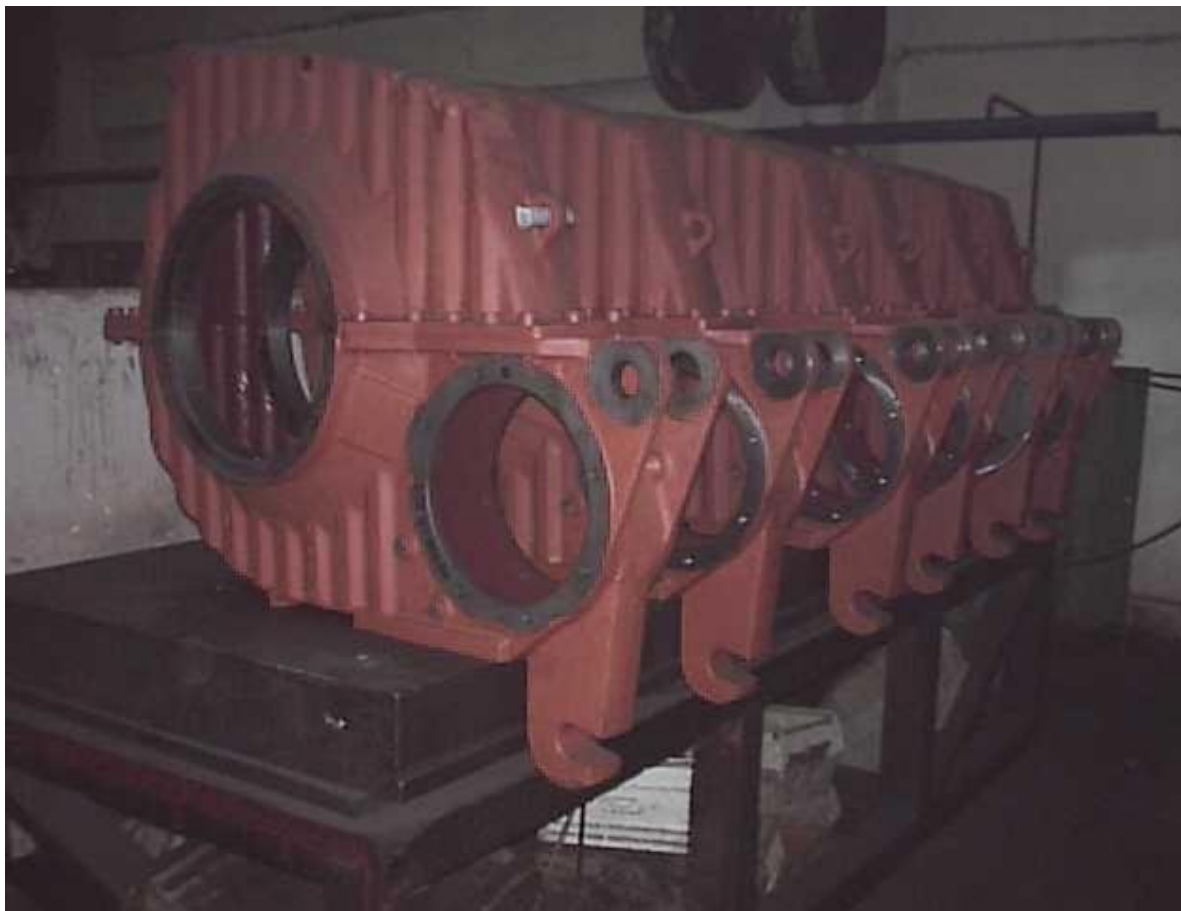
Slika 2.1. Strojno obrađeno kućište reduktora, (Preuzeto iz [4])
