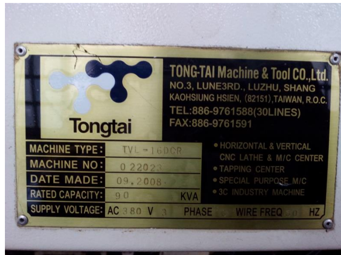
Slika 4.2. Natpisna pločica tokarilice Karusel CNC, (Fotografirano 12.11.2017.)
