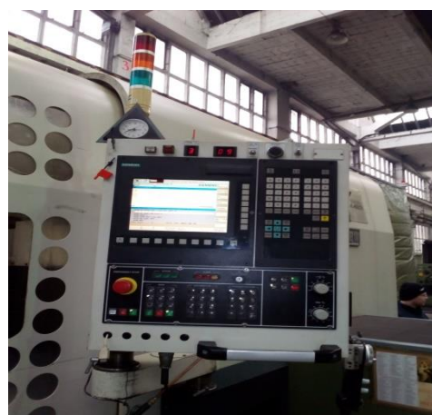
Slika 4.4. Upravljačka ploča tokarilice Karusel CNC, (Fotografirano 12.11.2017.)
