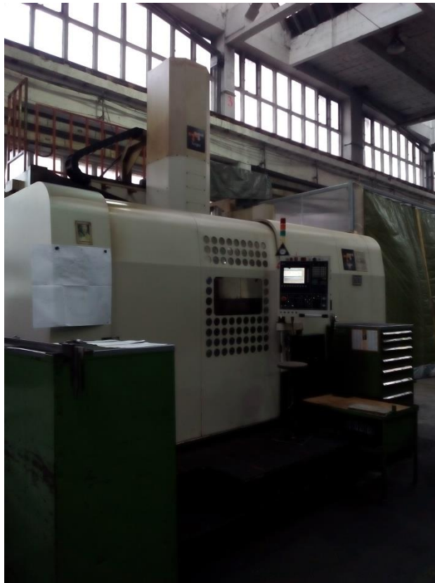
Slika 4.1. Tokarilica Karusel CNC, (Fotografirano 12.11.2017.)
