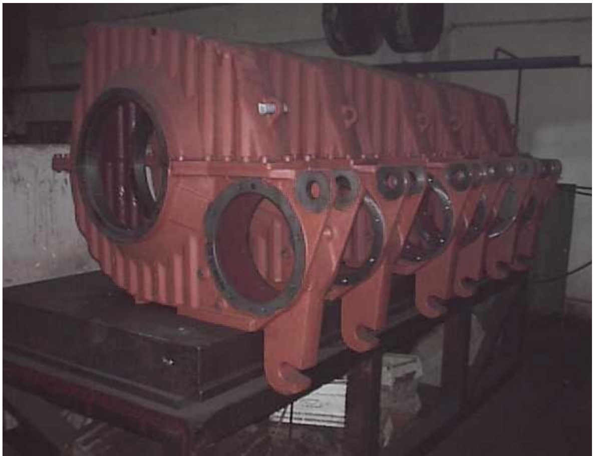
Slika 2.1. Strojno obrađeno kućište reduktora, (Preuzeto iz [4])
