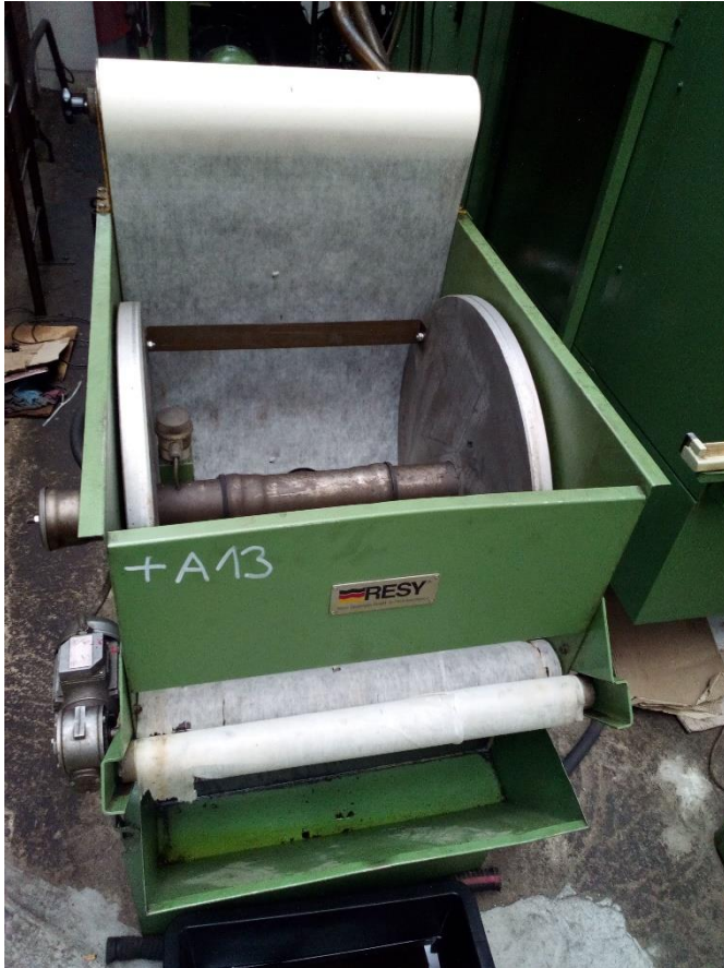
Slika 4.49. Pogon filtracije ulja, (Fotografirano 12.11.2016.)
