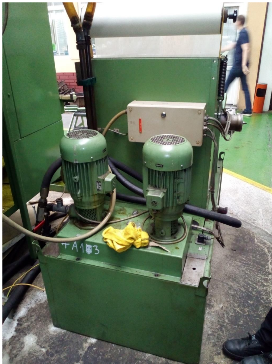
Slika 4.47. Glavni motori za pogon uljne pumpe, (Fotografirano 12.11.2016.)
