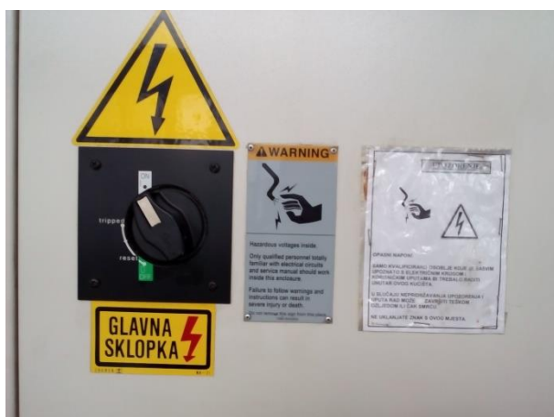
Slika 1.3. Glavna sklopka tokarilice Karusel CNC, (Fotografirano 12.11.2017.)
