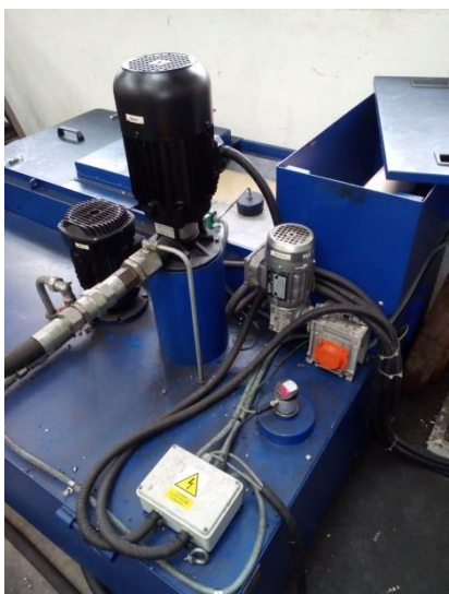
Slika 4.14. Motori za podmazivanje stroja uljem, (Fotografirano 12.11.2016.)
