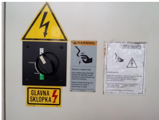
Slika 1.3. Glavna sklopka tokarilice Karusel CNC, (Fotografirano 12.11.2017.)
