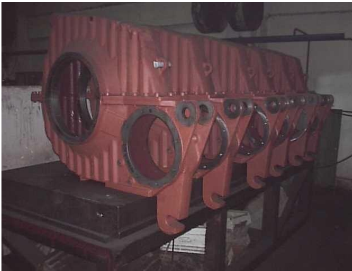
Slika 2.1. Strojno obrađeno kućište reduktora, (Preuzeto iz [4])
