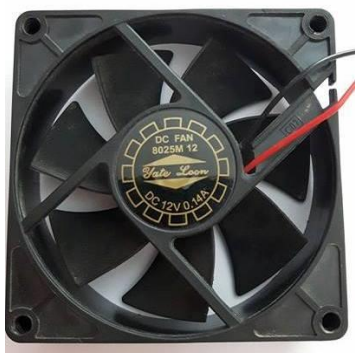
Slika 4.1.: DC motor 12V, 0.14A
