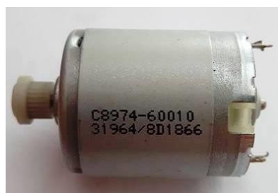
Slika 4.2.: DC motor (12V, 0.3A)
