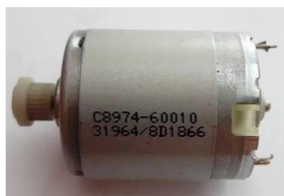
Slika 4.2.: DC motor (12V, 0.3A)
