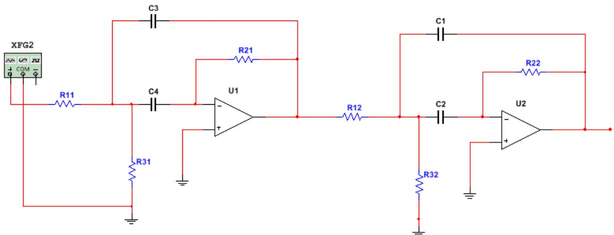
**Sl. 4.4** Simulacijski model frekvencijski selektivnog pojačala 4.reda
