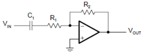
**Sl. 3.6** Invertirajući visokopropusni filter prvog reda [5]
