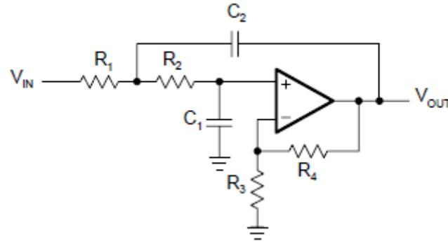
**Sl. 3.4** Niskopropusni filter 2.reda u *Sallen-Key* topologiji [5]
