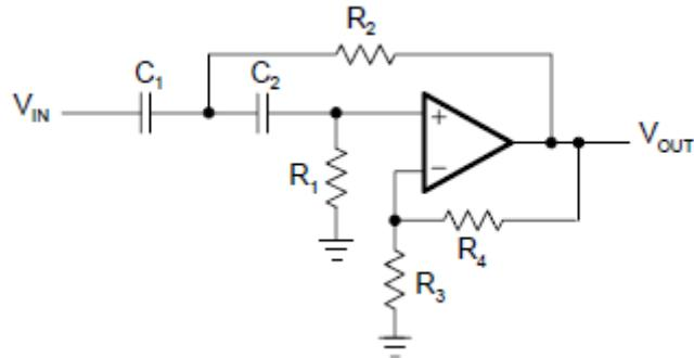
**Sl. 3.7** Visokopropusni filter 2.reda u *Sallen-Key* topologij [5]
