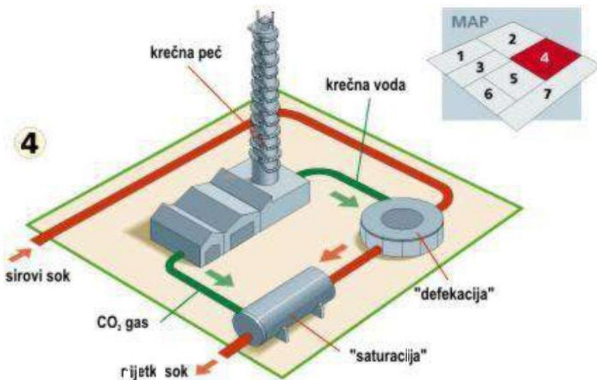
Slika 3.5 Proizvodnja vapnenog mlijeka i plina CO 2 u vapnenoj peći i čišćenje soka na saturaciji [1]
