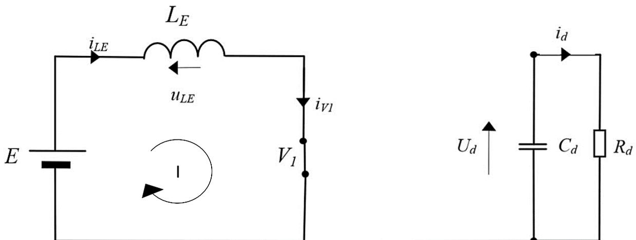
*Slika 4.1.2. Nadomjesna shema uzlaznog pretvarača za interval A*
