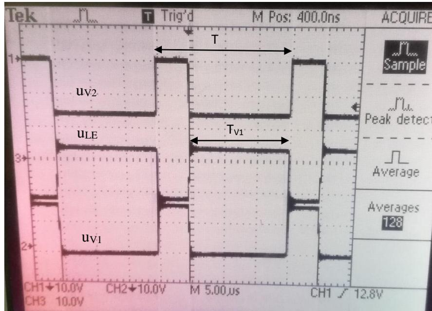
Slika 5.2.2.1. Valni oblik napona na induktivitetu  $u_{LE}$ , ventilu  $V_1$  i ventilu  $V_2$  pod rednim brojem 1
