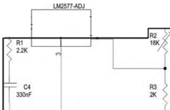
Slika 3.1.1. Upravljački podsustav istosmjernog pretvarača napona
