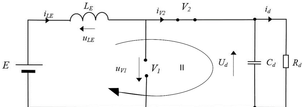
Slika 4.1.3. Nadomjesna shema uzlaznog pretvarača za interval B
