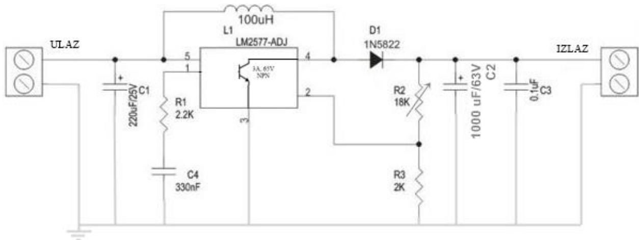
Slika 2.3. Shema promjenjenog istosmjernog uzlaznog pretvarača napona
