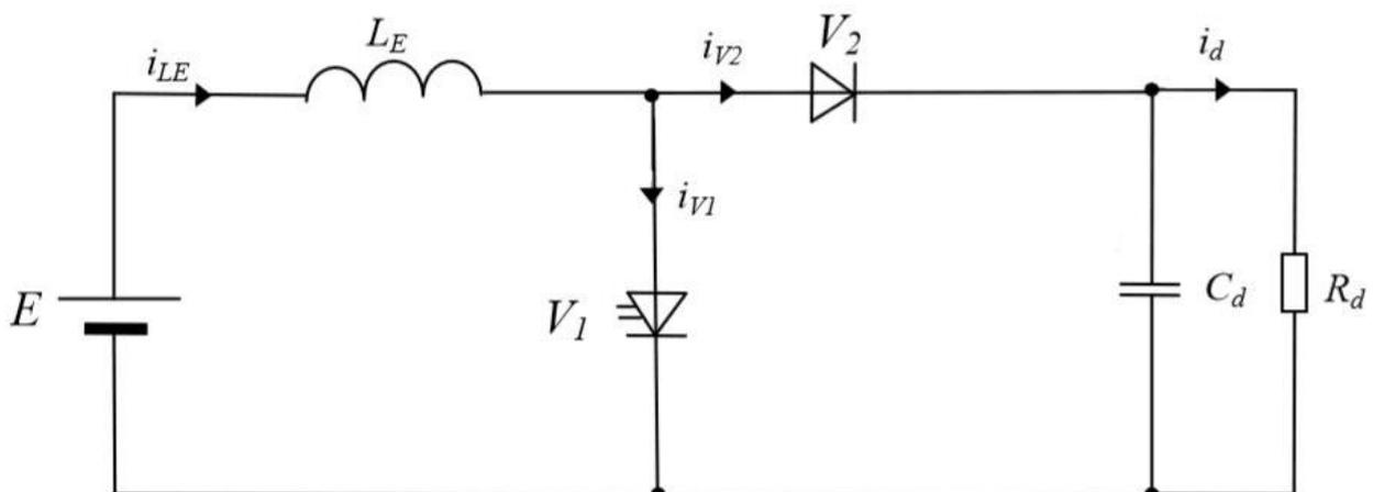
*Slika 2.2. Nadomjesna shema spoja istosmjernog uzlaznog pretvarača*
