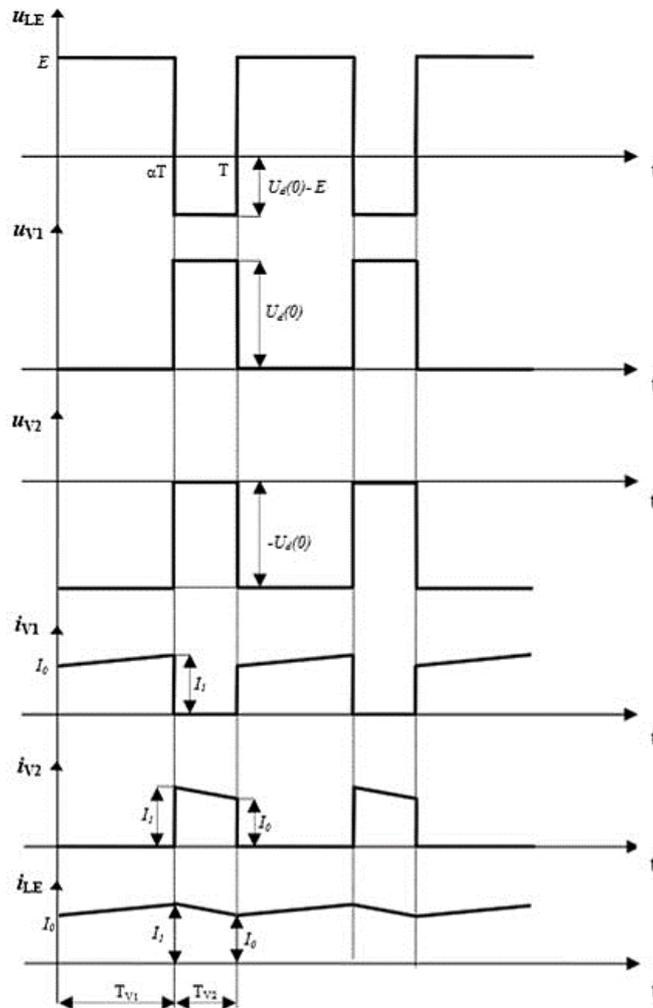
Slika 4.1.4. Valni oblici struja i napona na ventilima
