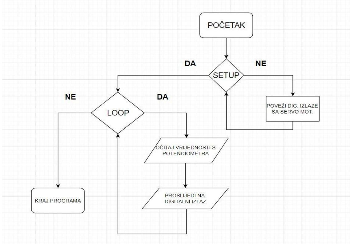
**Slika 3.17.** Blok dijagram algoritma [12]
