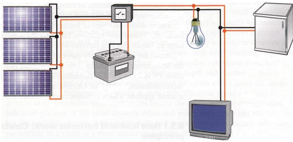
Slika 2.1. Samostalni fotonaponski sustav za trošila na istosmjernu struju [1]
