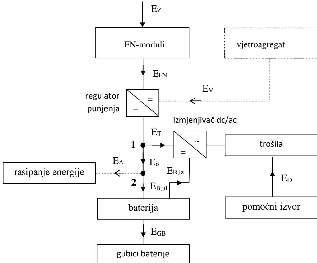
Slika2.4. Model samostalnoga fotonaponskog sustava[1]
