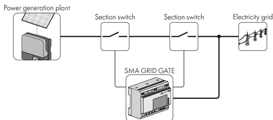
Slika3.2. načelo rada elektrane veće od 20 kW sa SMA Grid Gate-om[2]
