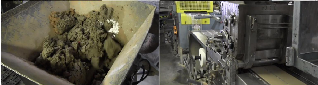
Sl.5.2.4. Proces postavljanja olovne sulfat paste na rešetkastu mrežu
