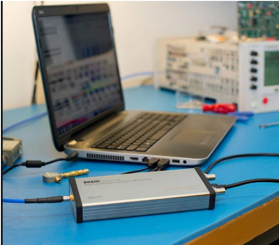
Slika 18. USB analizator spektra [6]
