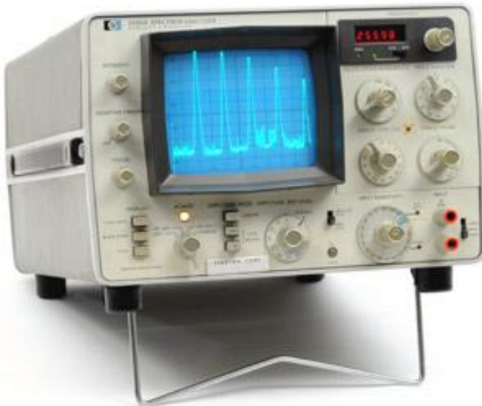
Slika 10. Analogni analizator spektra s katodnom cijevi [1]
