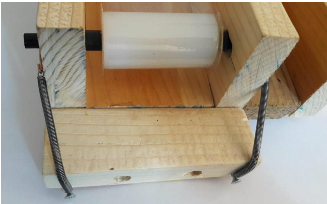
Slika 4.9. Postizanje napetosti trake pomoću opruga.
