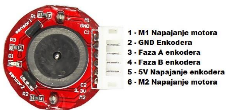
Slika 4.6. Prikaz ožičavanja motora i enkodera. [5]
