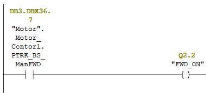
Slika 4.21. Mapiranje izlaznih digitalnih signala.
