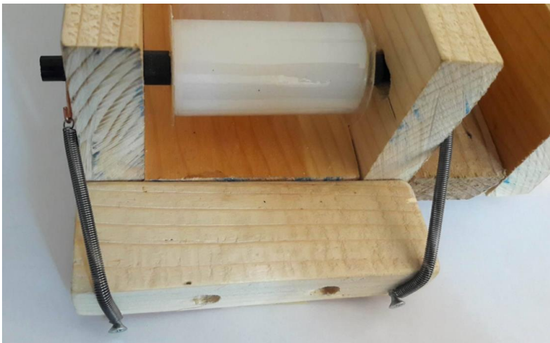
Slika 4.9. Postizanje napetosti trake pomoću opruga.
