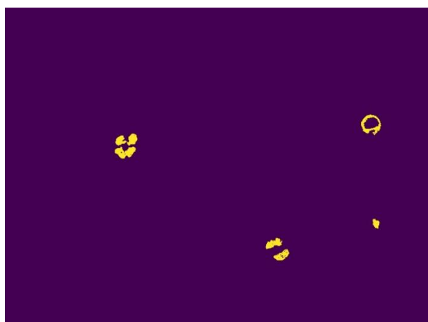
c) Uklanjanje manjih nakupina piksela i objekata s ruba slika
