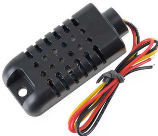
Sl. 3.6. DHT21 senzor [7]
