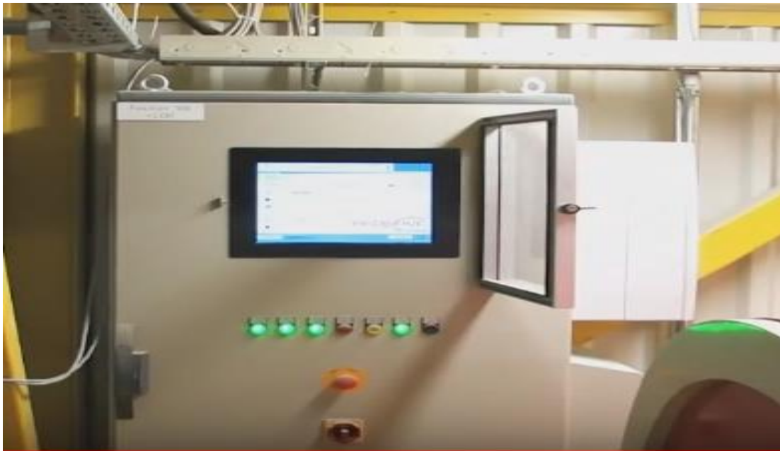
Sl. 4.1.4. Uredaj za utvrđivanje kvalitete stakla
