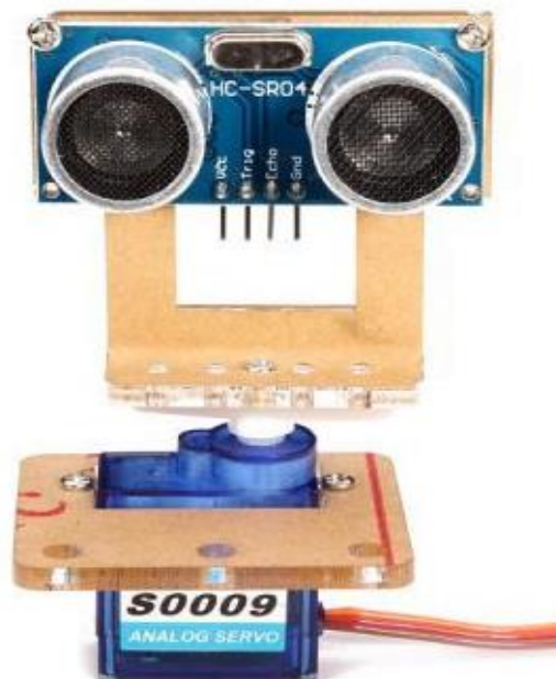
Sl. 5.1 Ultrazvučni senzor na servo motoru.[17]
