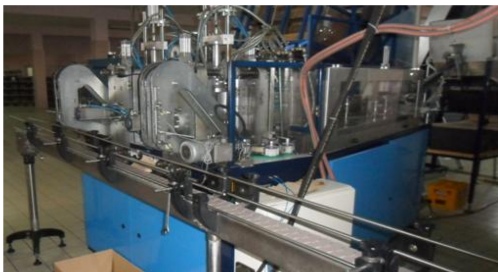
Slika 3.14. Druga stana stroja za puhanje boca
