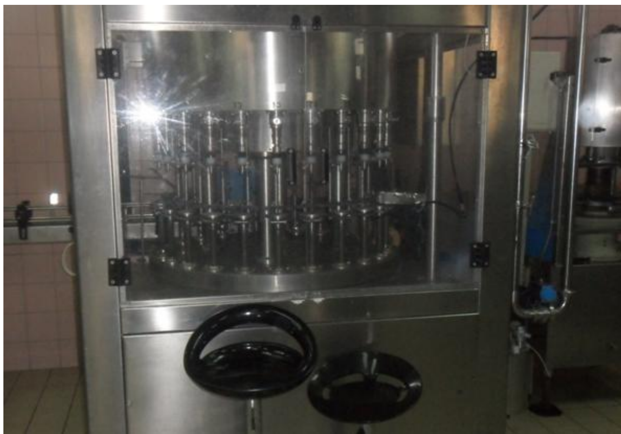
Slika 3.17. Punilica za negazirane voćne sirupe
