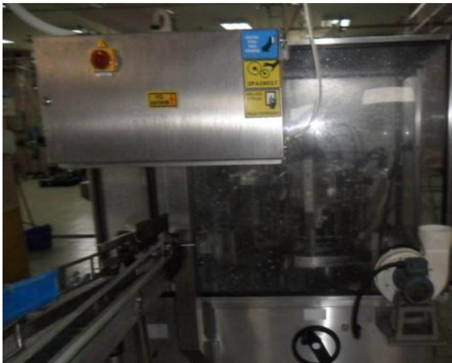
Slika 3.16. Prikaz komanditne kutije i zaštite u kojoj se nalazi dio stroja za ispiranje
