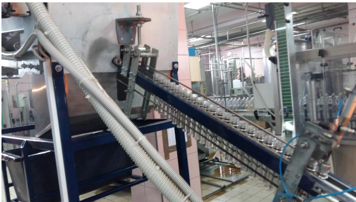
Slika 3.12. Dovod epruveta preko pokretnih valjka u puhalicu
