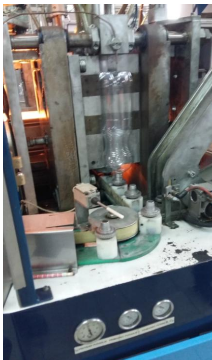
Slika 3.13. Kalup i gotovi proizvod ( PET boca)
