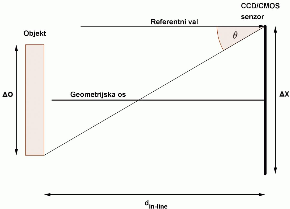
**Slika 2.4** Geometrijski izgled laboratorijskog postava za snimanje osnih holograma,  $\theta$  je maksimalni kut interferencije,  $\Delta O$  je duljina objekta, a  $\Delta X$  duljina senzora u ravnini promatrane geometrijske osi
