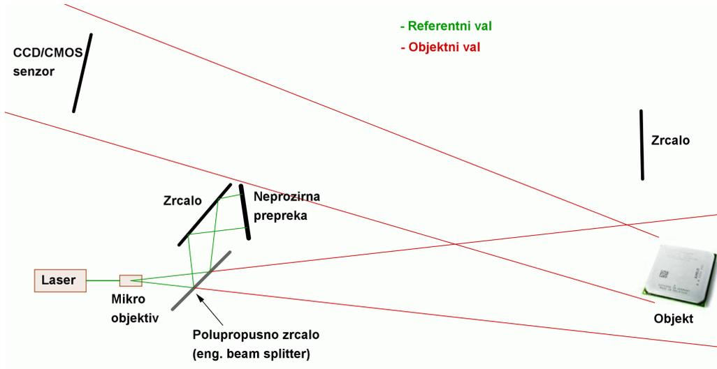
Slika 3.2 Izmjena laboratorijskog postava za snimanje objektnog vala
