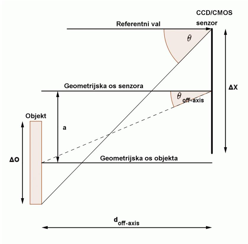
**Slika 2.6** Geometrijski izgled laboratorijskog postava za snimanje vanosnih holograma,  $\theta$  je maksimalni kut interferencije,  $\Delta O$  je duljina objekta, a  $\Delta X$  duljina senzora duž promatrane geometrijske osi
