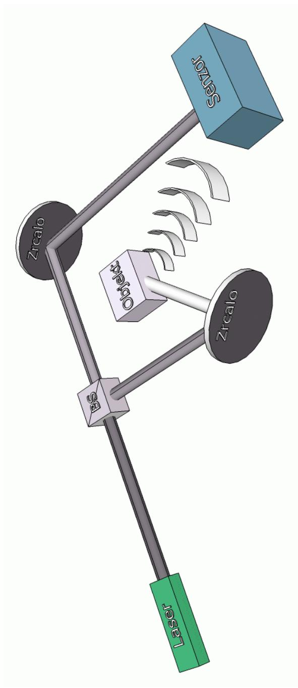
**Slika 2.5** Laboratorijski postav za snimanje vanosnih (off-axis) holograma,
