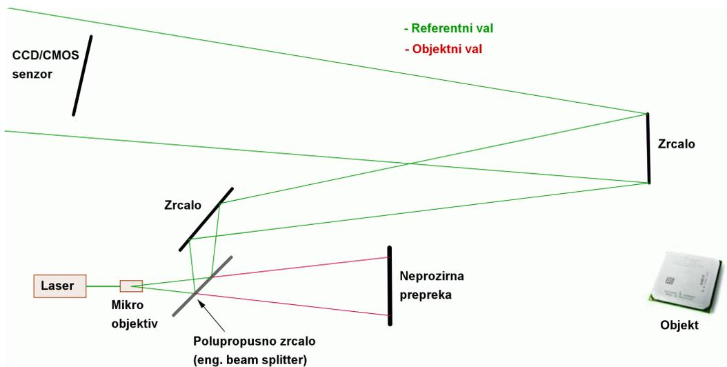
Slika 3.3 Izmjena laboratorijskog postava za snimanje referentnog vala
