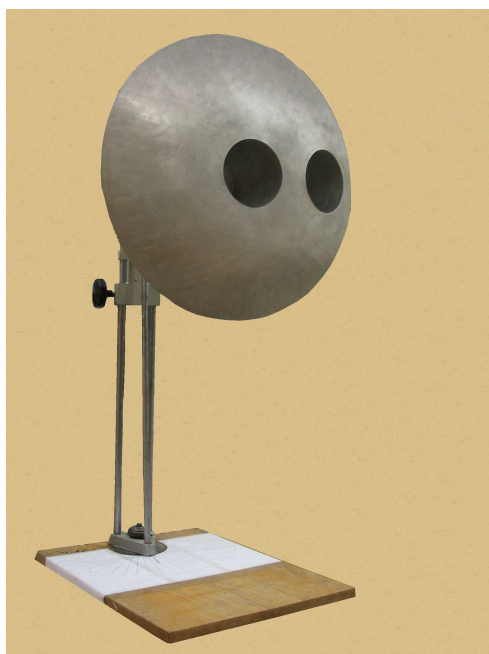
Slika 8.1. Sferni eksperimentalni model predstavljen s dva valovoda (radijus valovoda r_w=6\text{cm} ) na sferi radijusa r_s=69\text{cm} ( \alpha_1=0^\circ , \beta_{11}=0^\circ ; \alpha_2=18^\circ , \beta_{21}=90^\circ ) [57].
