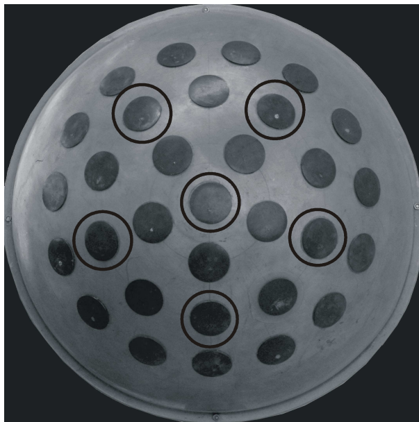
Slika 8.20. Aktivne mikrotrakaste antene sfernog niza ikosaedarskog rasporeda na sferi radijusa 30 cm ( \alpha_1=0^\circ , \beta_{11}=0^\circ , \alpha_2=30^\circ , \beta_{21}=0^\circ , \beta_{22}=72^\circ , \beta_{23}=144^\circ , \beta_{24}=216^\circ , \beta_{25}=288^\circ ).
