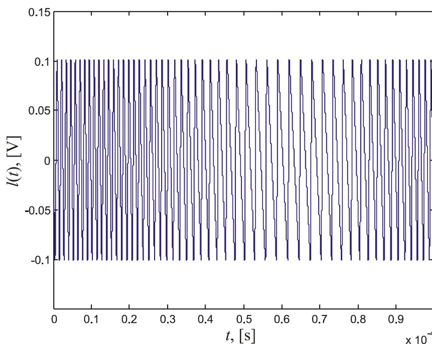
Slika 4.15. Izlazni signal iz integratora  $l(t)$  uz primjenu metode 1 za  $m_{ASD}(t) = 0,8\sin(2\pi 4000t)$
