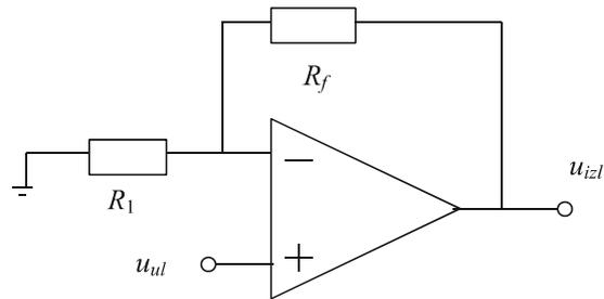
Slika 3.4. Neinvertirajući spoj operacijskog pojačala
