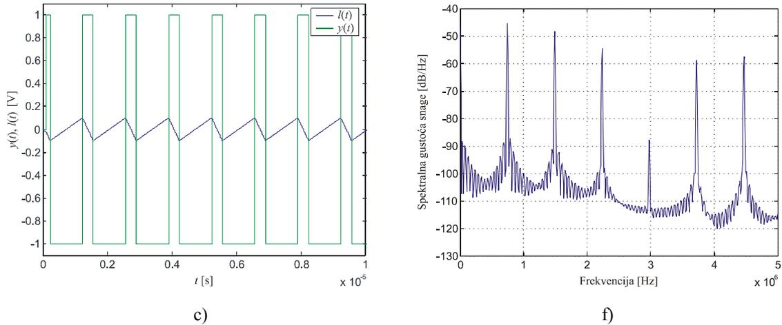
Slika 4.20. Valni oblici  $y(t)$  i  $l(t)$  kada je  $m_{ASD} = -0,5$  za a) idealni ASD modulator, b) modulator s kašnjenjem  $t_k = 100$  ns i c) primjenu metode 2 te spektralna gustoća snage  $y(t)$  za d) idealni ASD modulator, e) modulator s kašnjenjem  $t_k = 100$  ns i f) primjenu metode 2
