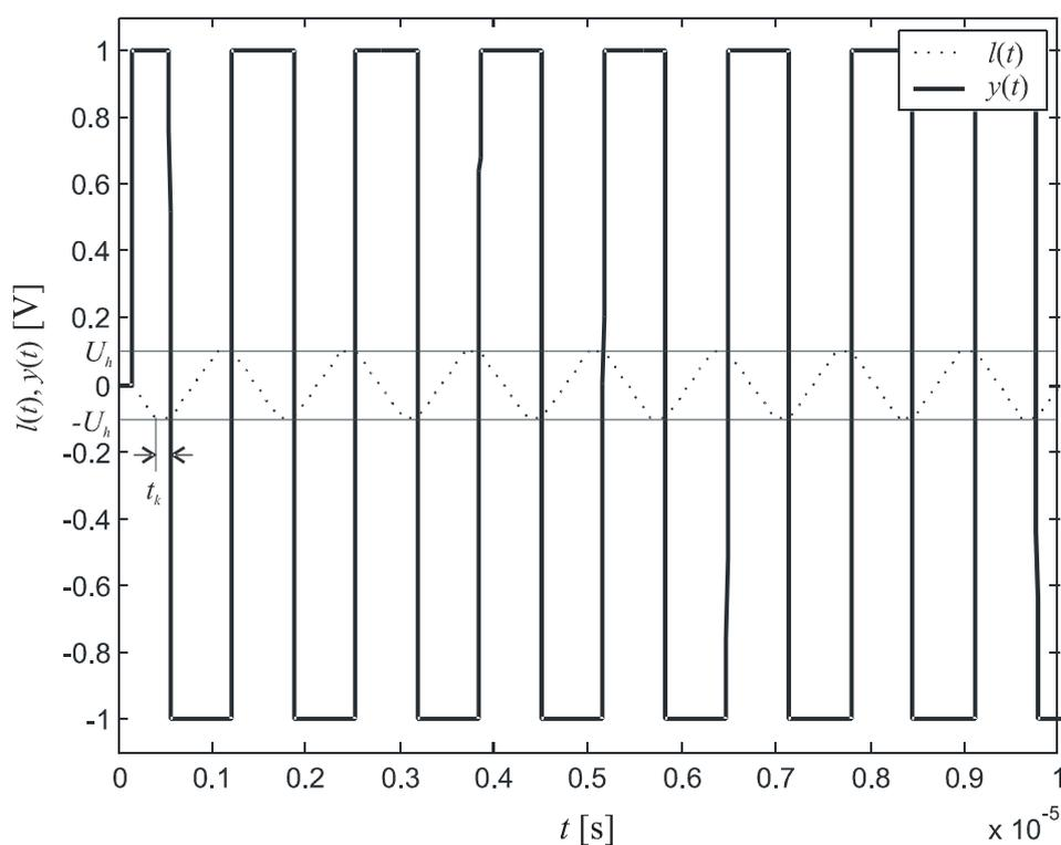
Slika 3.27. Ulazni napon  $l(t)$  i izlazni napon  $y(t)$  Schmittovog komparatora uz kašnjenje komparatora  $t_k$  i ograničen napon na integratoru  $l(t)$  za  $m_{ASD} = 0$
