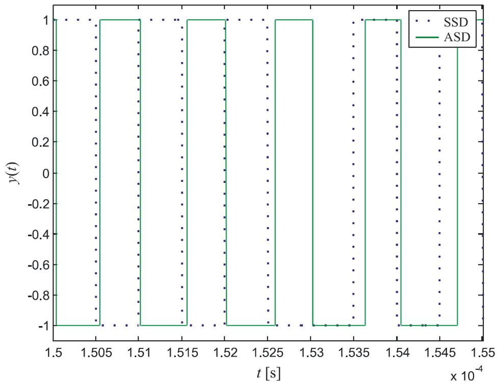
Slika 2.18. Izlazni signal iz SSD i ASD modulatora
