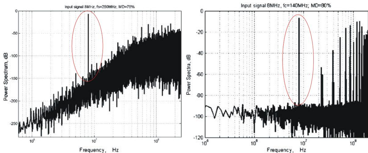
Slika 2.19. Usporedba spektra SSD i ASD moduliranog signala [11]
