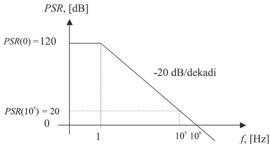
Slika 3.16. Faktor potiskivanja smetnji iz linija napajanja  $PSR$  u ovisnosti o frekvenciji [60]
