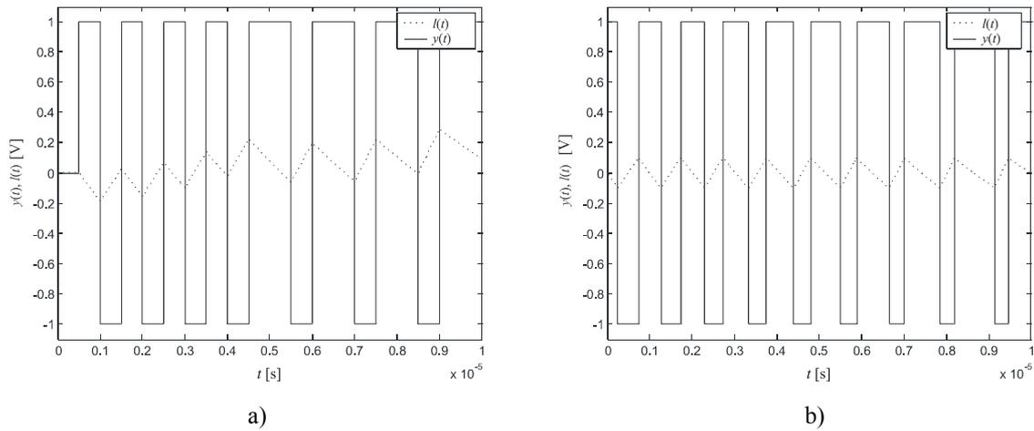
Slika 2.17. Valni oblici  $y(t)$  i  $l(t)$  za a) SSD i b) ASD modulator
