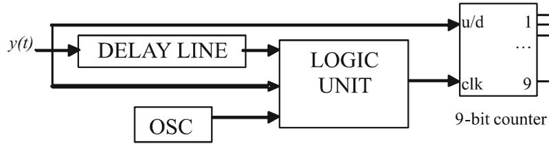
Slika 4.24. Vremensko-digitalni pretvornik (TDC)
