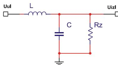
Slika 4.35. LC-filtar na izlazu pojačala snage D klase
