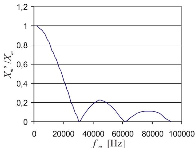
Slika 4.32. Amplitudno-frekvencijska karakteristika digitalnog filtra
