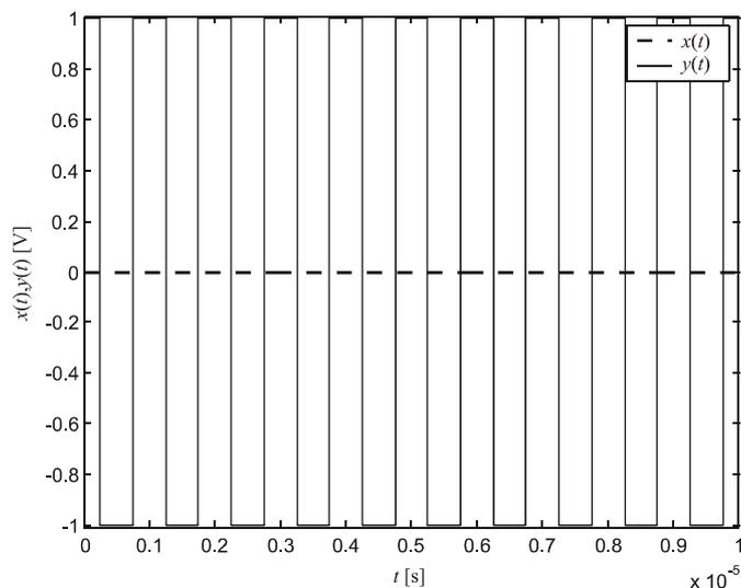
Slika 4.28. Izlaz iz ASD modulatora za  $x(t) = 0$  V
