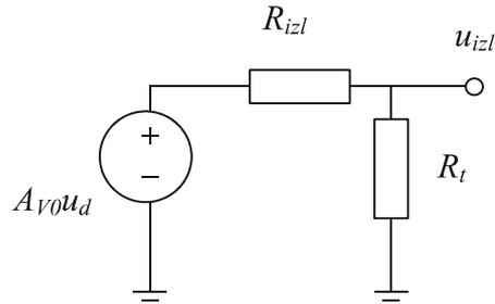
Slika 3.7. Utjecaj izlaznog otpora na izlazni napon
