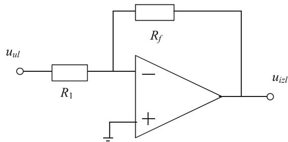
Slika 3.3. Invertirajući spoj operacijskog pojačala
