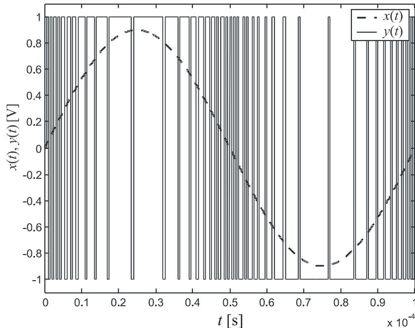
Slika 2.2. Izlazni signal SSD modulatora  $y(t)$  za sinusni ulazni signal  $x(t)$
