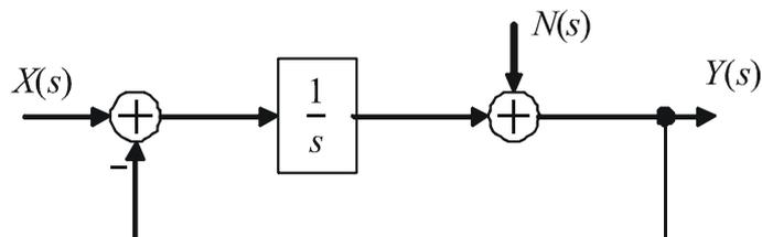
Slika 2.3. Sigma-delta modulator prvog reda u frekvencijskoj domeni
