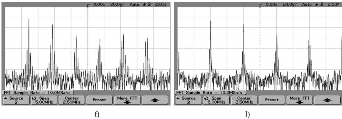
Slika 5.9. Valni oblici  $y(t)$  i  $l(t)$  i frekvencijski spektri  $y(t)$  bez primjene metode 2 za a) i d)  $m_{ASD} = 0$ ; b) i e)  $m_{ASD} = 0,5$ ; c) i f)  $m_{ASD} = -0,5$  te s primjenom metode 2 za g) i j)  $m_{ASD} = 0$ ; h) i k)  $m_{ASD} = 0,5$ ; i) i l)  $m_{ASD} = -0,5$
