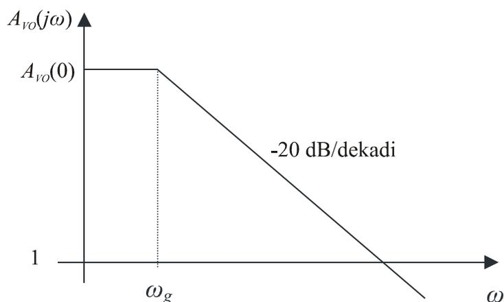
Slika 3.5. Frekvencijska ovisnost naponskog pojačanja operacijskog pojačala
