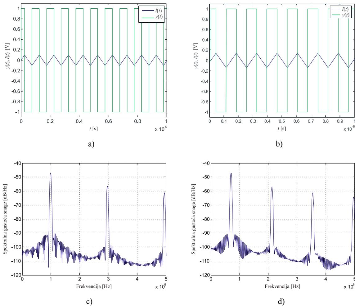
Slika 4.2. Valni oblici signala  $l(t)$  i  $y(t)$  uz  $m_{ASD} = 0$  za a) idealni i b) realni ASD modulator s  $t_k = 100$  s, te spektre izlaznog signala  $y(t)$  za c) idealni i d) realni ASD modulator
