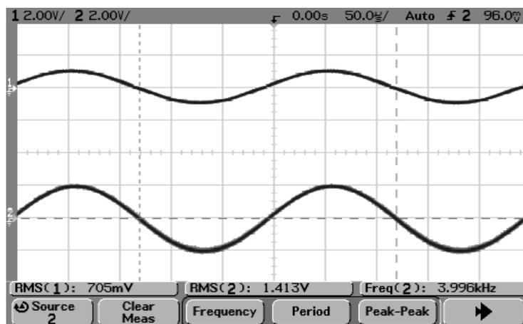
Slika 5.15. Valni oblik ulaznog i izlaznog napona pojačala snage klase-D
