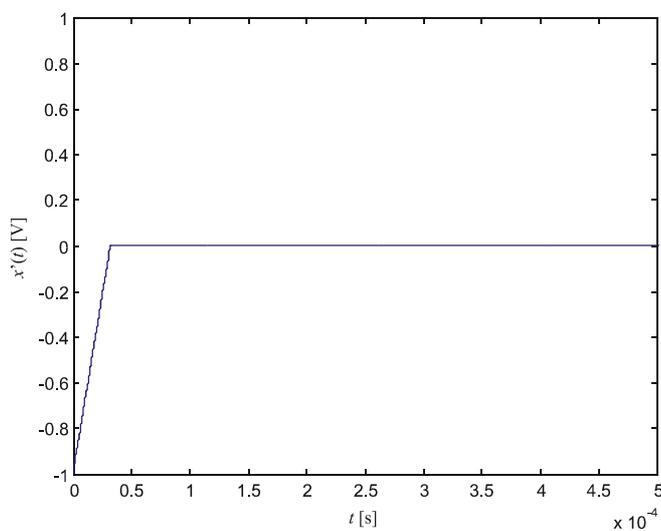
Slika 4.29. Demodulirani signal  $x'(t)$  A/D pretvornika za  $x(t) = 0$
