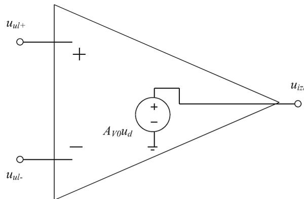
Slika 3.2. Uz definiciju naponskog pojačanja idealnog operacijskog pojačala (zanemareni ulazni i izlazni otpori operacijskog pojačala)
