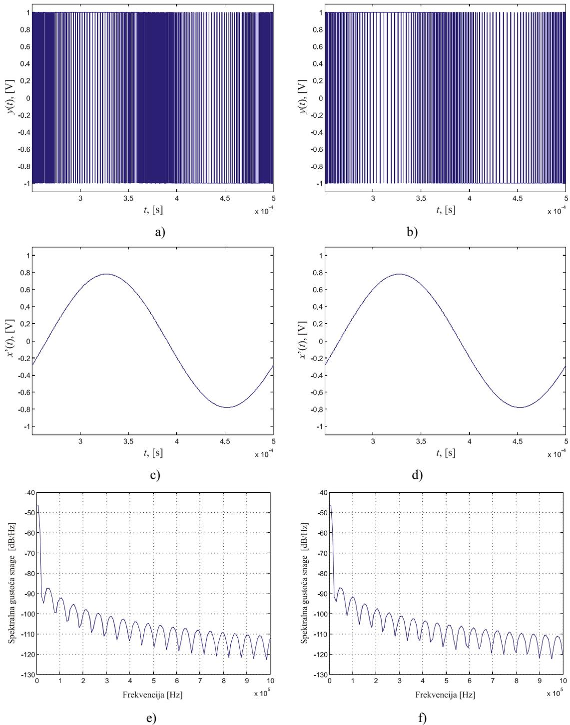
Slika 4.8. Valni oblici  $y(t)$  uz  $x(t) = 0,8\sin(2\pi 4000t)$  za a) model bez kašnjenja, b) s kašnjenjem  $t_k = 100$  ns; valni oblici  $x'(t)$  za c) model bez kašnjenja, d) s kašnjenjem  $t_k = 100$  ns; spektri demoduliranog signala  $x'(t)$  za e) model bez kašnjenja, f) s kašnjenjem  $t_k = 100$  ns
