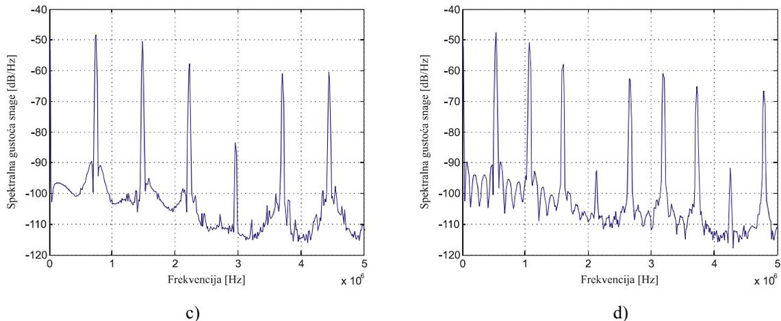
Slika 4.4. Valni oblici signala  $l(t)$  i  $y(t)$  uz  $m_{ASD} = -0,5$  za a) idealni i b) realni ASD modulator s  $t_k = 100$  ns, te pripadajući spektri izlaznog signala  $y(t)$  za c) idealni i d) realni ASD modulator
