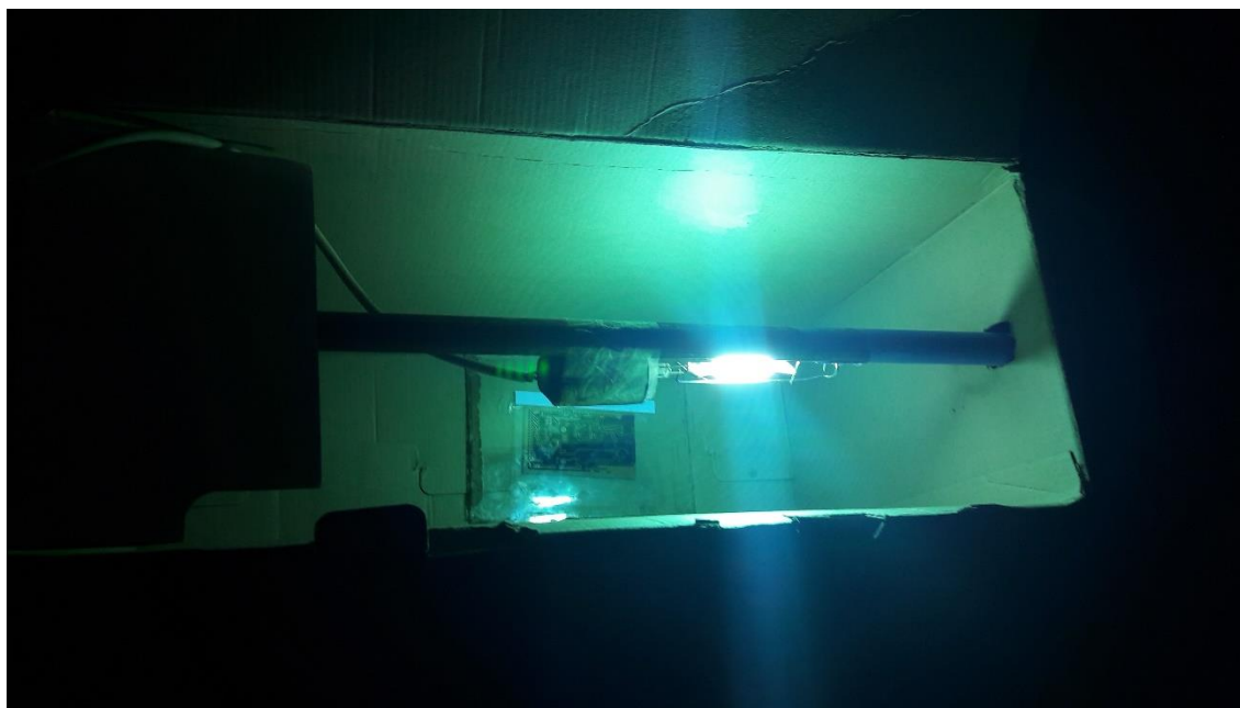
Sl. 3.21. Osvjetljivanje tiskane pločice
