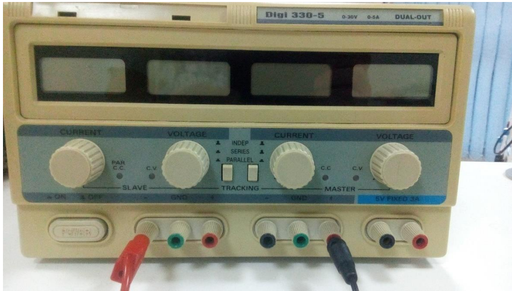
Slika 5.10. Istosmjerni izvor Digi 330-5
