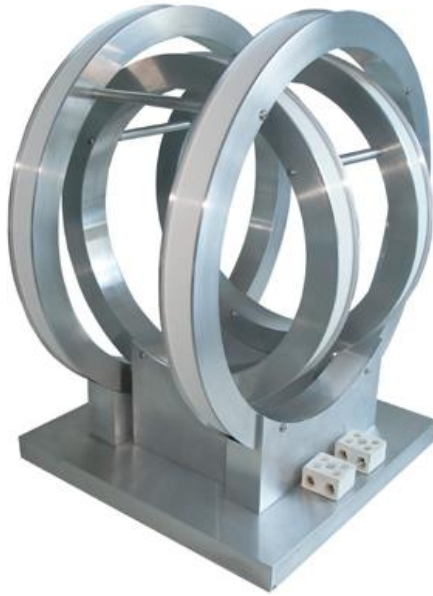
Slika 3.2. Helmholtzov sustav svitaka sa dva para svitaka [12]
