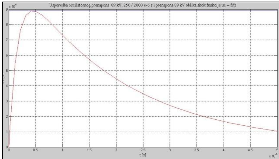
Slika 2.19. Usporedba sklopnog prenapona u_c(t) 93,75 kV, 250 / 2000 \mu s i prenapona u_0(t) 93,75 kV oblika skokovite funkcije
