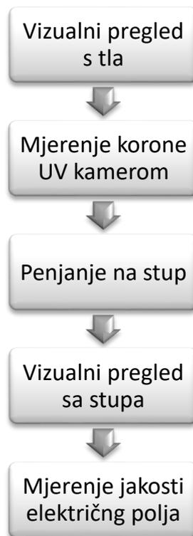
*Sl. 3.23. Postupak otkrivanja grešaka (oštećenja) na kompozitnim izolatorima [14].*
