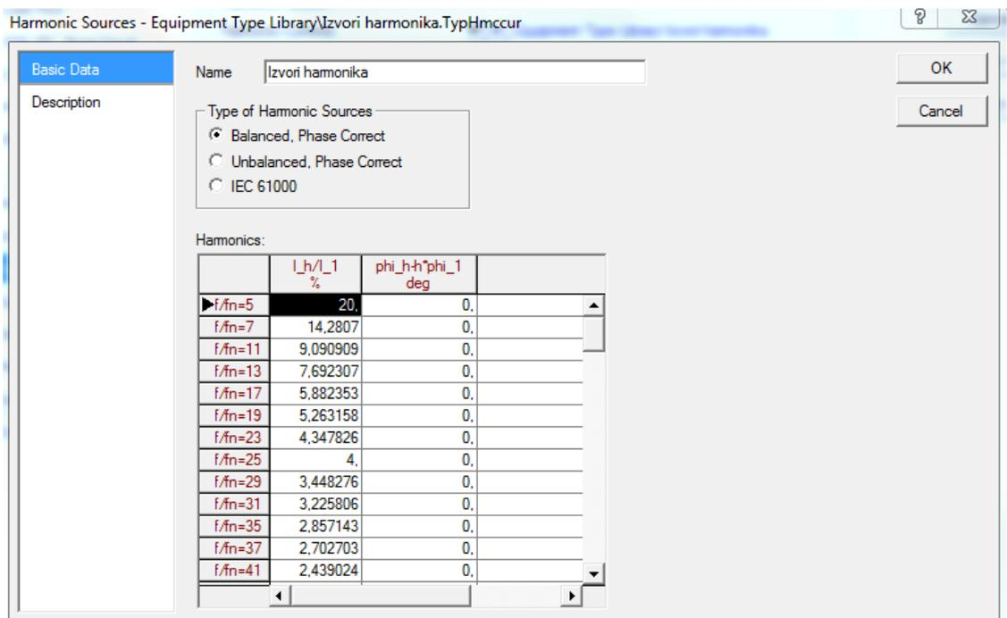
Slika 4.4.: Simetrični harmonijski izvor - omjeri frekvencija [5]
