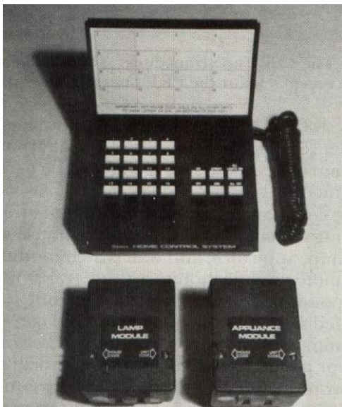
Sl. 2.1. BSR sustav X10 sa svjetiljkom i modulom aparata [2]
