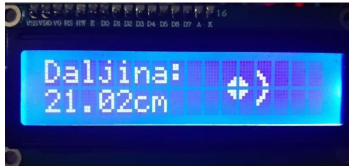
**Slika 4.2.** Izgled zaslona na udaljenosti od 21 cm
