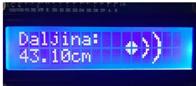
**Slika 4.3.** Izgled zaslona na udaljenosti od 43 cm
