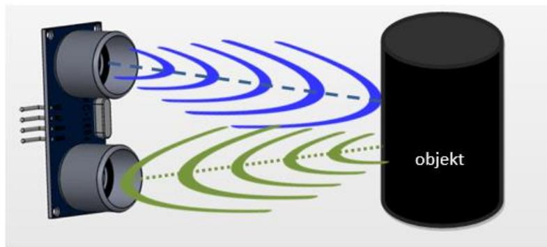
**Slika 2.7.** Rad ultrazvučnog senzora *HC-SR04* [11]
