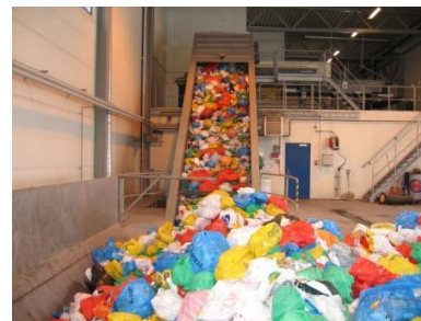
Sl. 4.27. Transportiranje otpada prema jedinici za razvrstavanje
