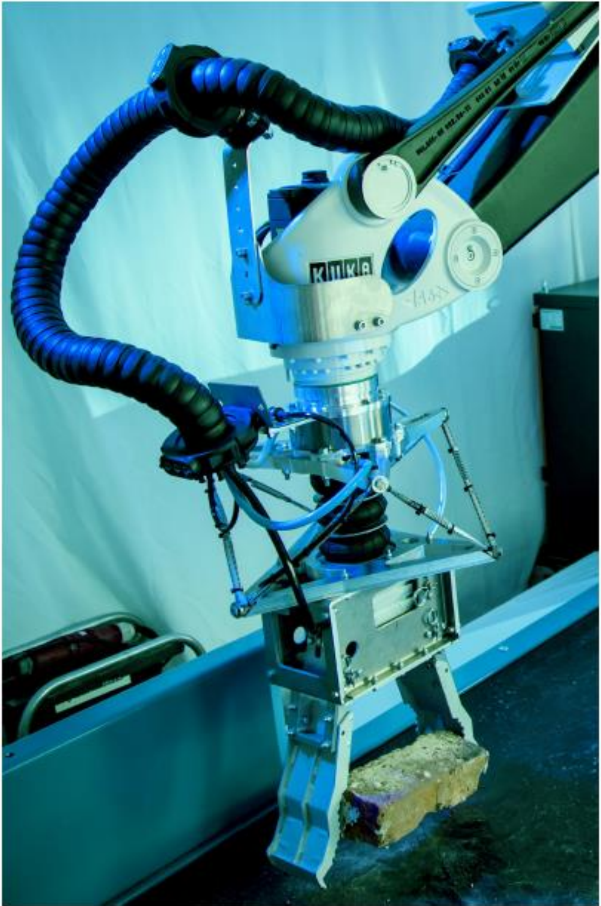
Sl. 4.9. Pneumatska hvataljka ZenRobotics Recycler-a
