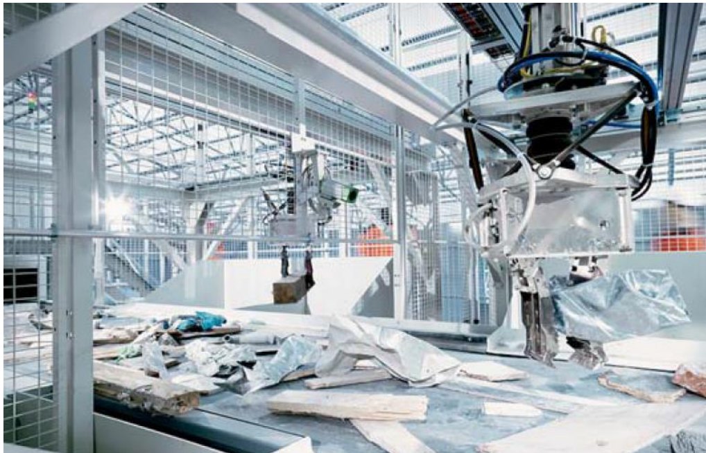
Sl. 4.13. Rad robotskog manipulatora ZenRobotics-a
