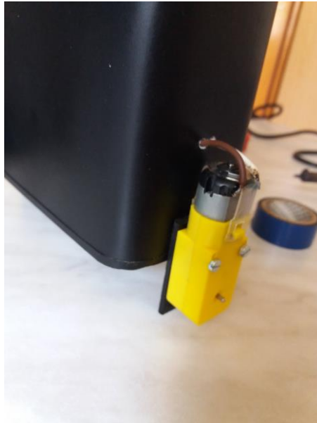
Sl. 3.21. Montirani motor sa lamelicom na kutiju
