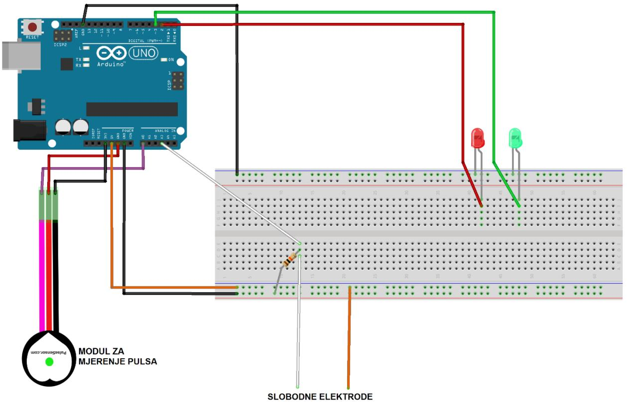
**Sl. 3.3.** Shema sklopolja jednostavnog detektora laži
