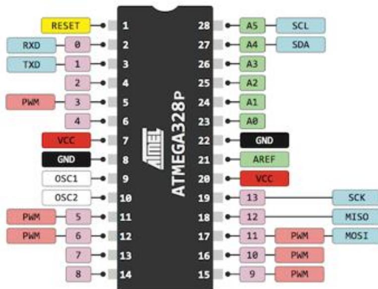
Sl.3.4. Raspored priključnica na Atmega328P mikroupravljaču [10]
