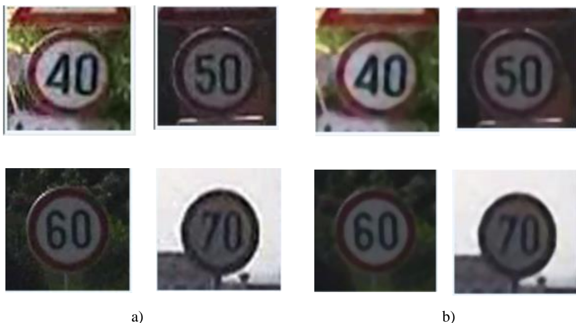
Slika 4.1. Prikaz djelovanja medijan filtera na više različitih primjera (b) u odnosu na originalne slike (a)
