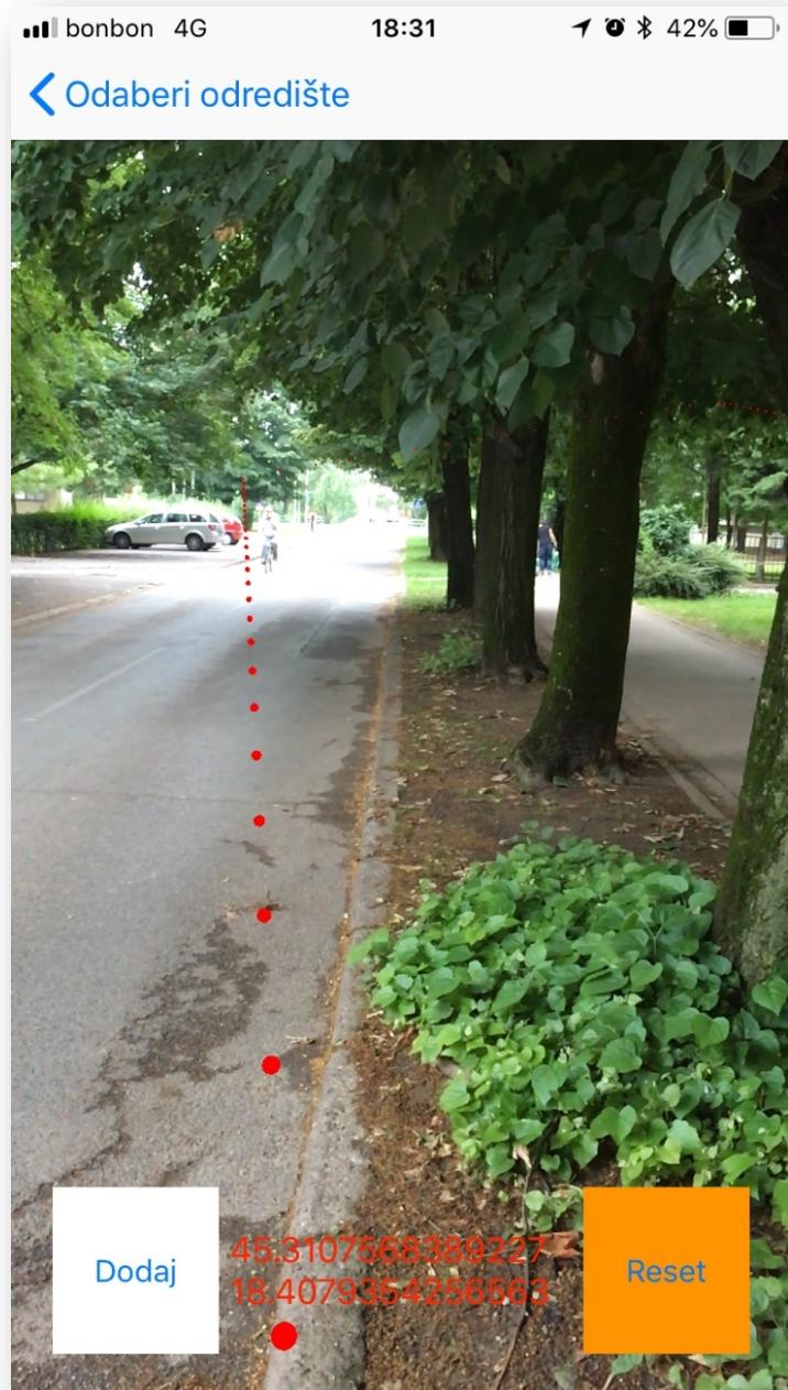
Sl. 4.2. Pogreška u očitanju vrijednosti azimuta s kompasa
