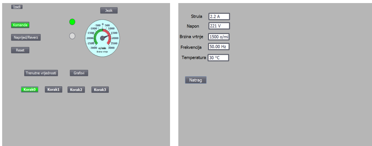
Slika 4.3. Izgled glavnog izbornika (lijevo) i podizbornika trenutnih vrijednosti (desno) za kombinaciju drugog i prvog koraka.
