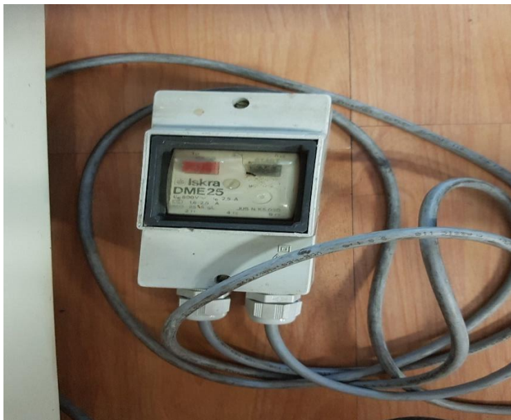
Slika 3.9. Motorna zaštitna sklopka Iskra DME 25.
