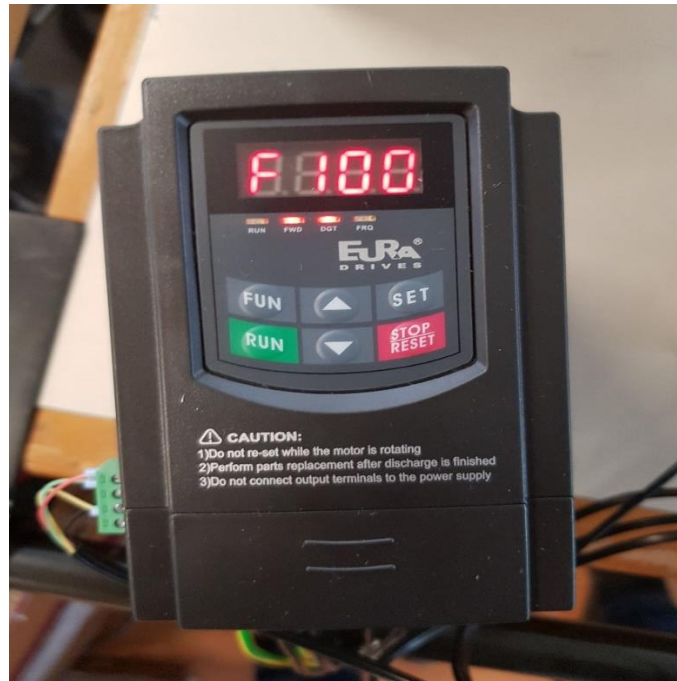
Slika 3.8. Frekvencijski pretvarač EURA E800.
