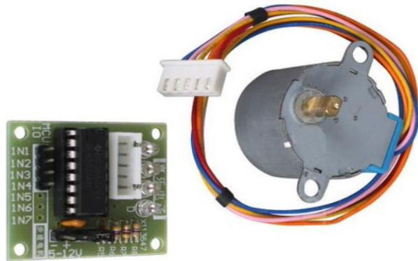
Slika 3.6. Upravljačka pločica ULN2003 i koračni motor 28BYJ-48[14]
