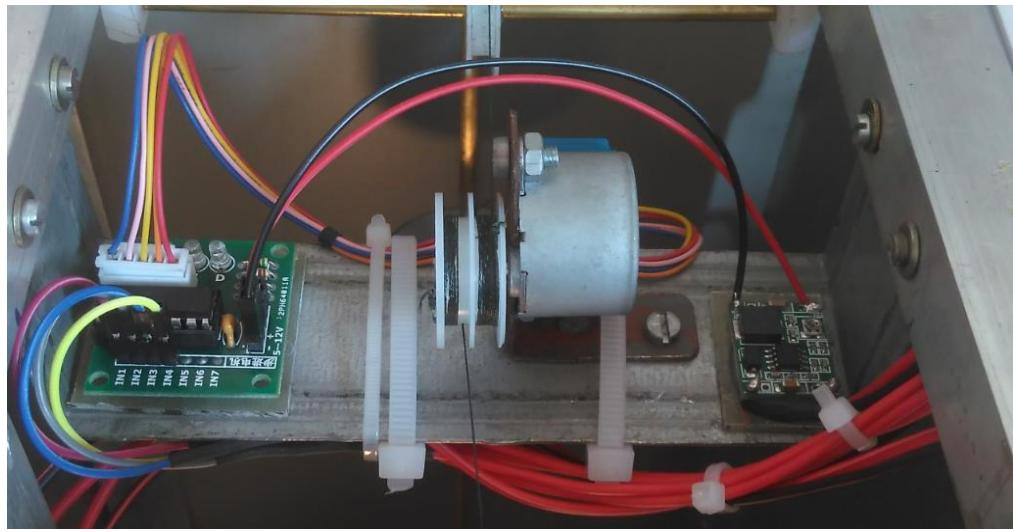
Slika 4.4. Koračni motor za podizanje i spuštanje kabine
