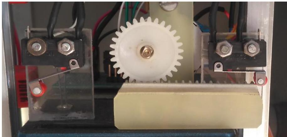
Slika 4.1. Mikroprekidači za otvaranje i zatvaranje vrata
