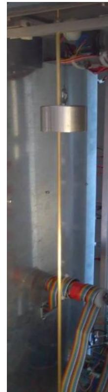
Slika 3.11. Protuteg s pripadajućom vodilicom
