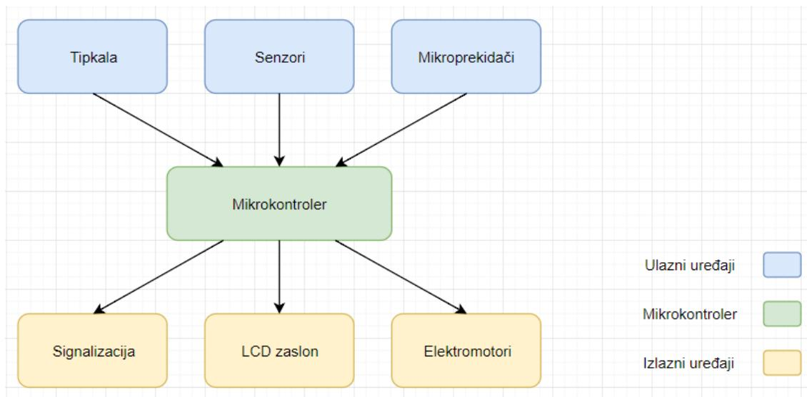
Slika 2.1. Strukturalni blok dijagram
