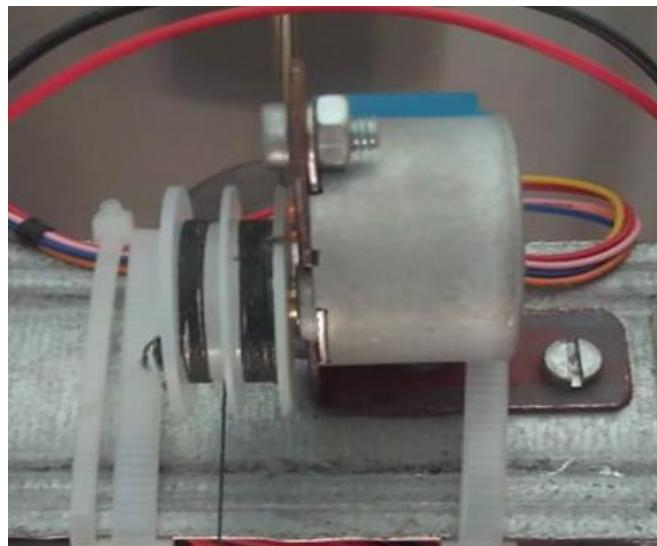
Slika 3.7. Koračni motor za podizanje i spuštanje kabine
