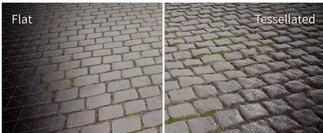
Sl. 2.7. Prikaz teselacijskog shadera na primjeru kaldrme.
