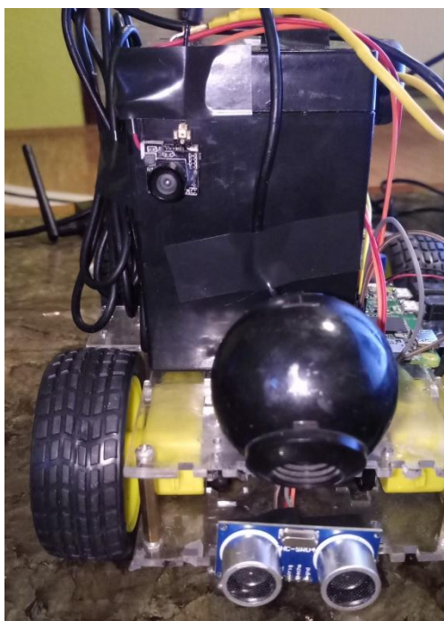
Slika 3.15. Platforma nakon dodane mini FPV kamere
