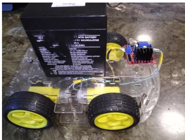
Slika 3.12. Platforma nakon dodanog napajanja
