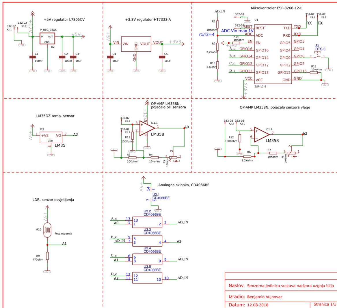
Shema 2.2: Shematski prikaz sustava za automatizirano mjerjenje
