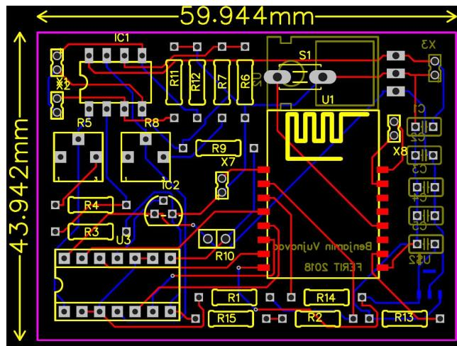
Slika 2.13: Predložak tiskane pločice sustava automatiziranog mjerjenja.
