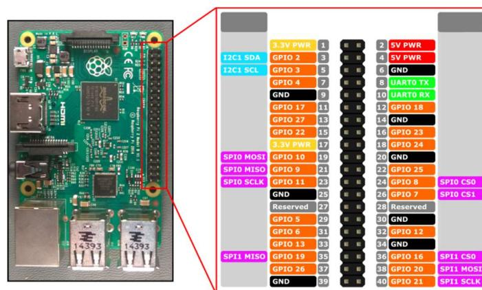
Slika 4.2.: Raspored pinova „Raspberry Pi 3“ računalne platforme
