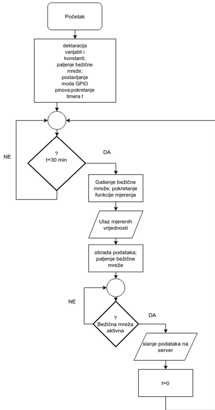
Slika 2.17: Algoritam upravljanja sustavom za automatizirano mjerjenje
