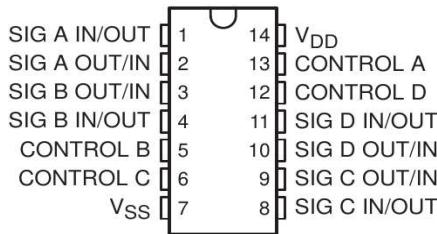
Slika 2.12: Rasporед pinova analogne sklopke CD4066BE
