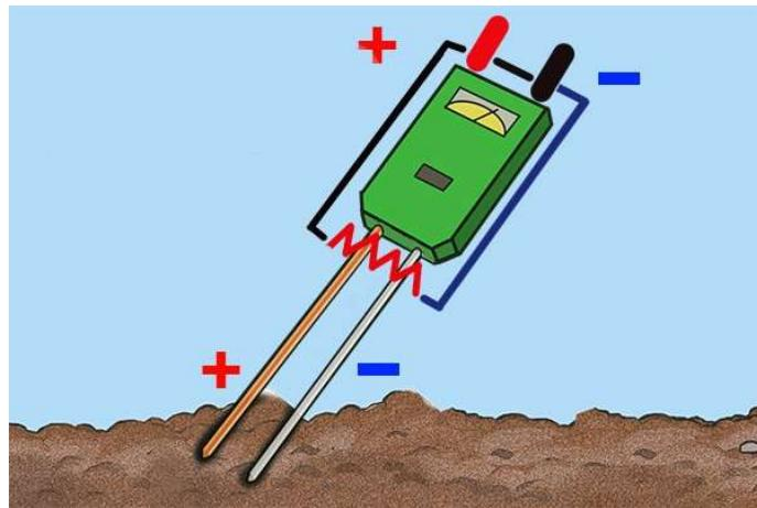
*Slika 2.4: Prikaz mjerjenja pH faktora tla korištenjem analognog pH metra s metalnim elektrodama*
