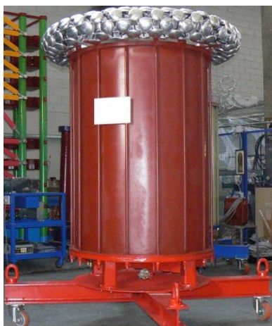
Sl.5.1.4. Ispitni transformator tipa cilindar
