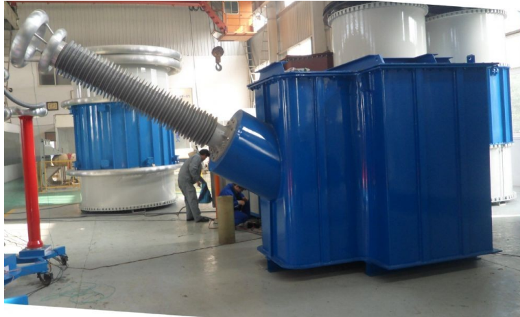
Sl.5.1.3. Ispitni transformator sa metalnim spremnikom
