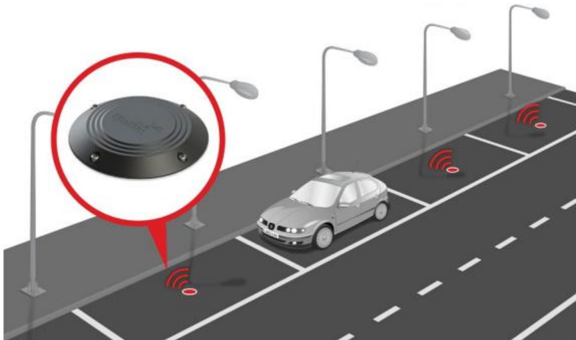
Slika 5.4. Primjer korištenja magnetskog senzora za otkrivanje prisutnosti. [24]
