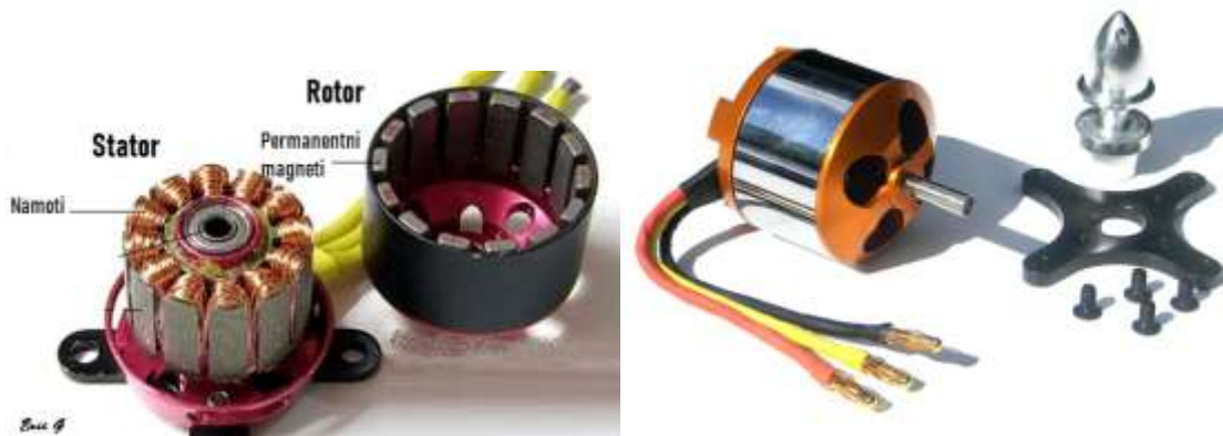
Sl. 3.9. BLDC motor (lijevo-rastavljeni, desno-nerastavljeni)
