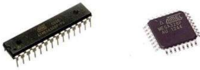
Sl. 3.4. Mikrokontroleri Atmega328
