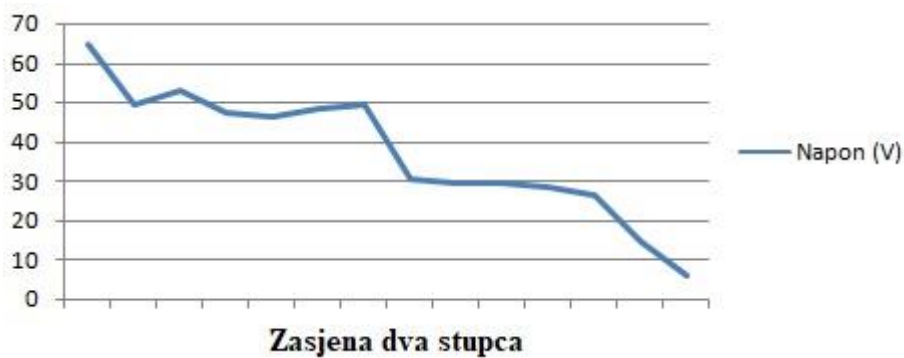
Slika 4.45. Zasjenjena dva stupca modula
