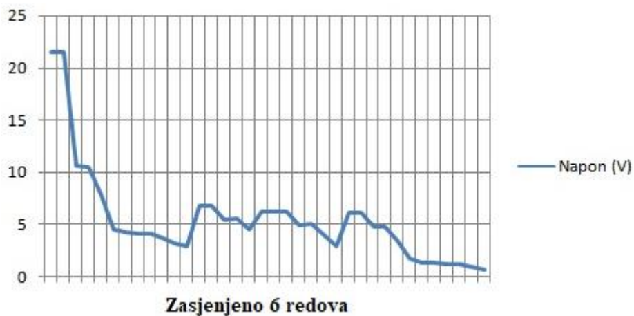
Slika 4.16. Promjena napona pri zasjeni 6 redova modula
