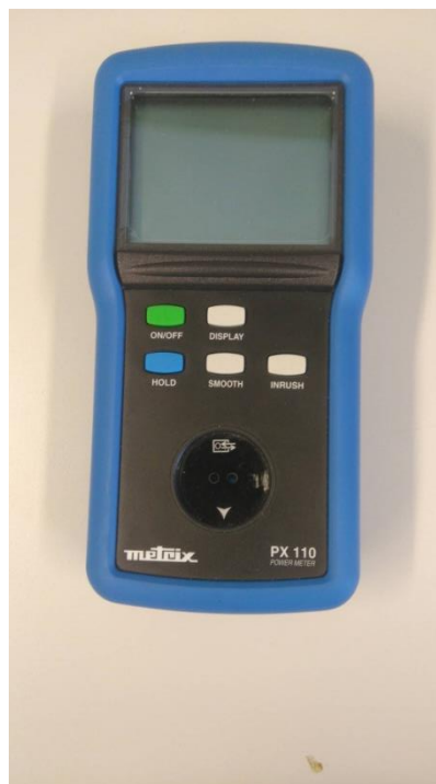
Slika 4.5. Mjerni uređaj Metrix PX-110 Powermeter
