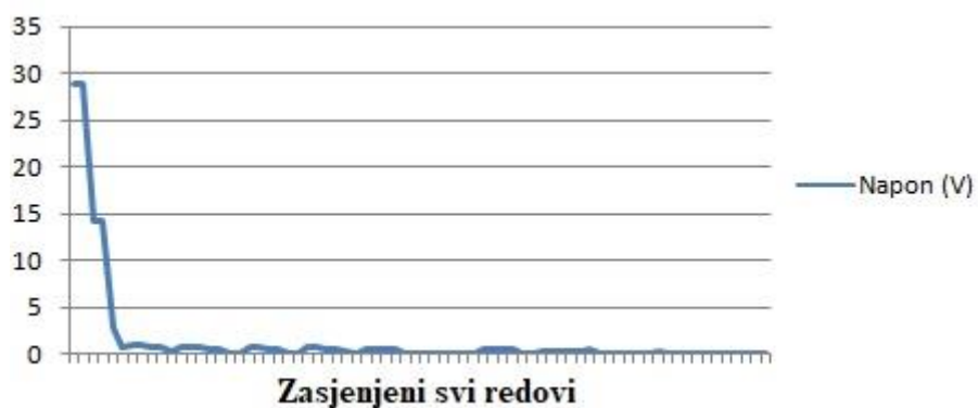
Slika 4.33. Napon pri kompletno zasjenjenom modulu odnosno svih 12 redova.
