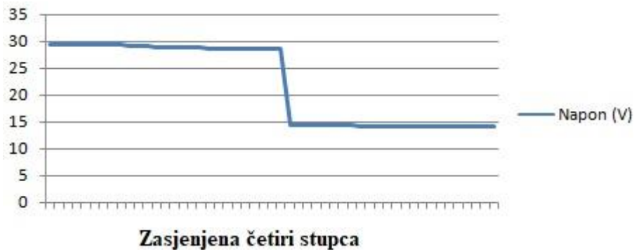
Slika 4.28. Promjena napona pri zasjeni četiri stupca fotonaponskog modula.
