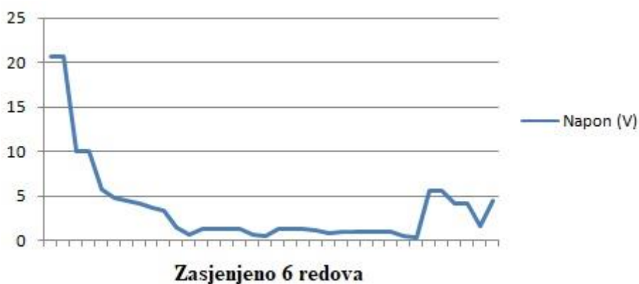
Slika 4.24. Promjena napona pri zasjeni 6 redova modula
