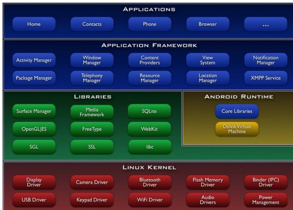
Sl. 2.3. Arhitektura Android operativnog sustava, prema [4].
