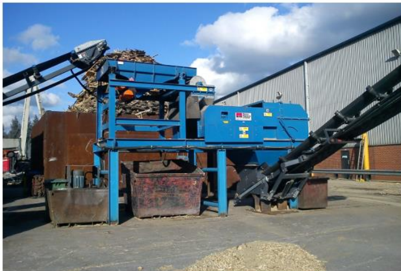
Slika 4.3. Separator na principu vrtložnih struja tvrtke Mastermagnets
