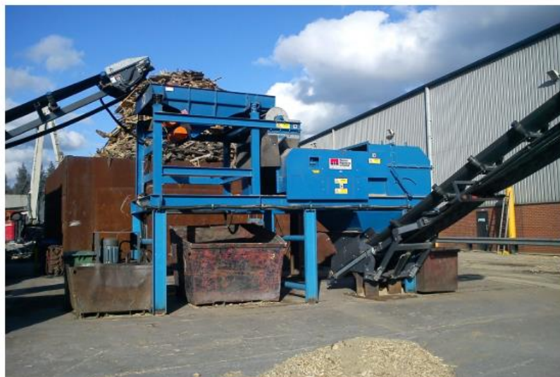
Slika 4.3. Separator na principu vrtložnih struja tvrtke Mastermagnets
