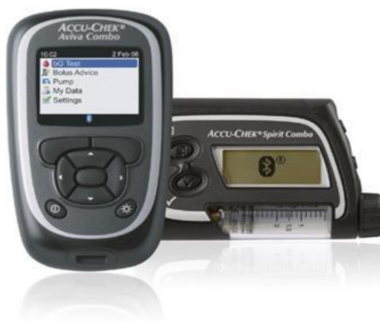
Fotografija 3.2. Sustav umjetne gušterače [4]
