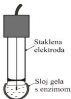
Ilustracija 4.2. Enzimska indikatorska elektroda [13]
