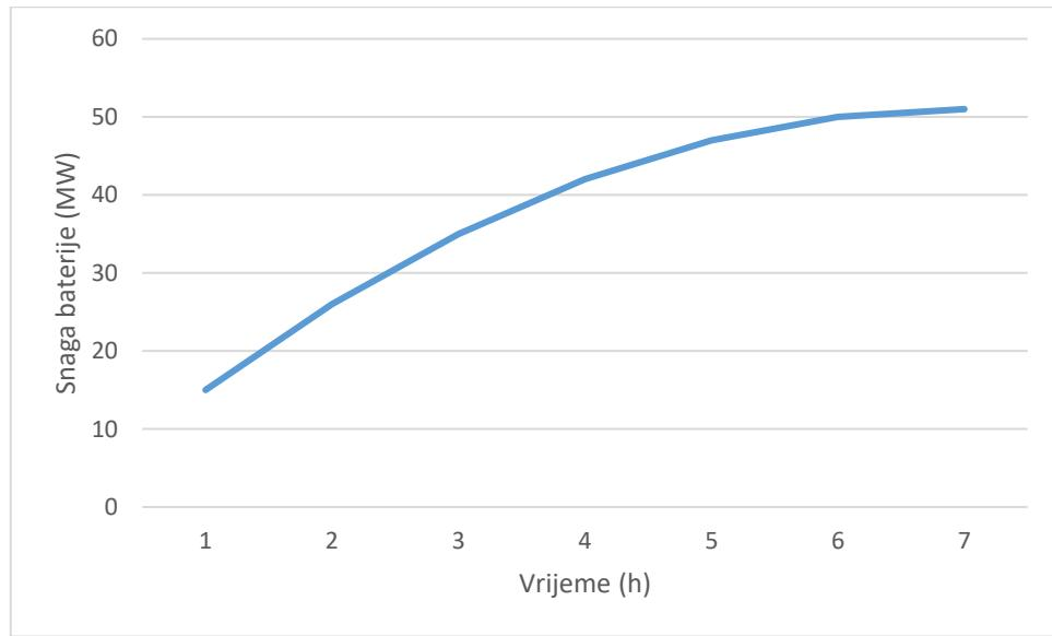
**Slika 4.3.** Grafički prikaz promjene snage baterije u promatranom vremenu za  $D=1 \text{ MW}$
