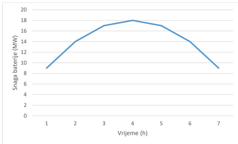
**Slika 4.15.** Grafički prikaz promjene snage baterije u promatranom vremenu za  $D=7 \text{ MW}$
