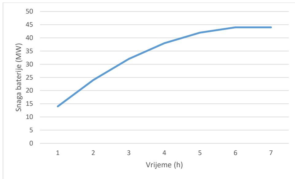
**Slika 4.5.** Grafički prikaz promjene snage baterije u promatranom vremenu za  $D=2 \text{ MW}$
