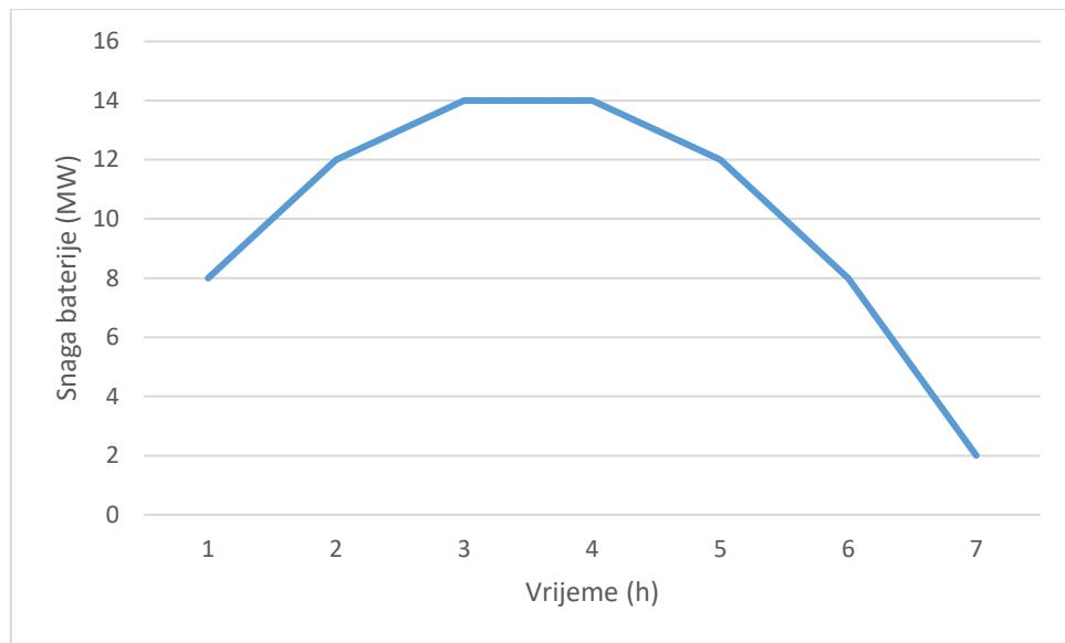
**Slika 4.17.** Grafički prikaz promjene snage baterije u promatranom vremenu za  $D=8 \text{ MW}$
