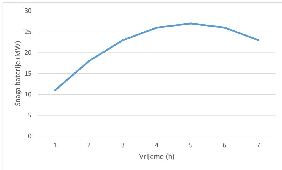
**Slika 4.11.** Grafički prikaz promjene snage baterije u promatranom vremenu za  $D=5 \text{ MW}$
