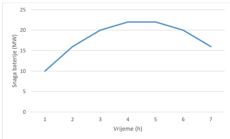
**Slika 4.13.** Grafički prikaz promjene snage baterije u promatranom vremenu za  $D=6 \text{ MW}$
