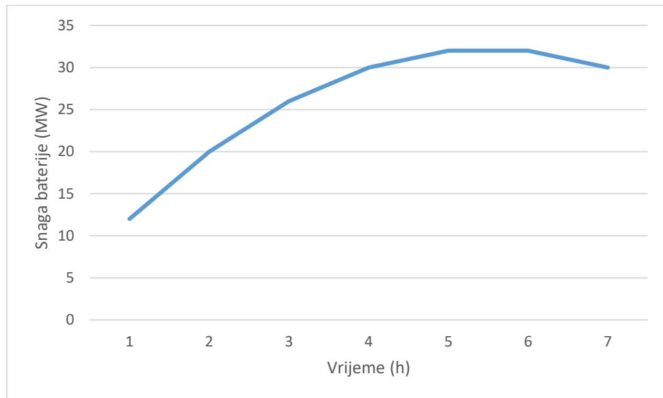
**Slika 4.9.** Grafički prikaz promjene snage baterije u promatranom vremenu za  $D=4 \text{ MW}$
