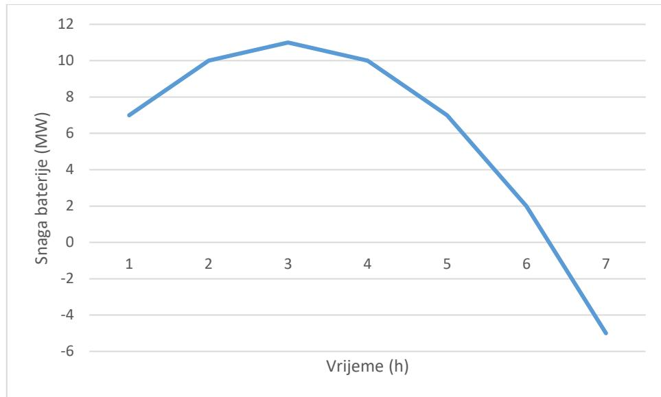
**Slika 4.19.** Grafički prikaz promjene snage baterije u promatranom vremenu za  $D=9 \text{ MW}$
