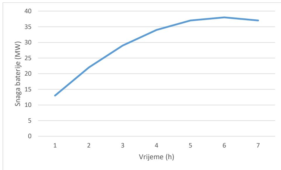
**Slika 4.7.** Grafički prikaz promjene snage baterije u promatranom vremenu za  $D=3 \text{ MW}$
